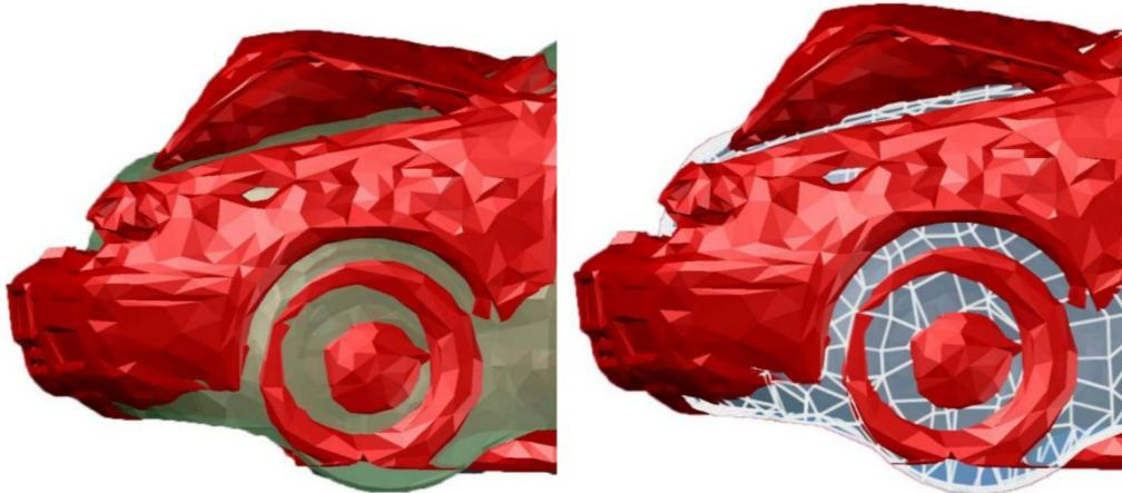
Slika 7. Primjena fotogrametrije u procjeni deformacije vozila [10]
