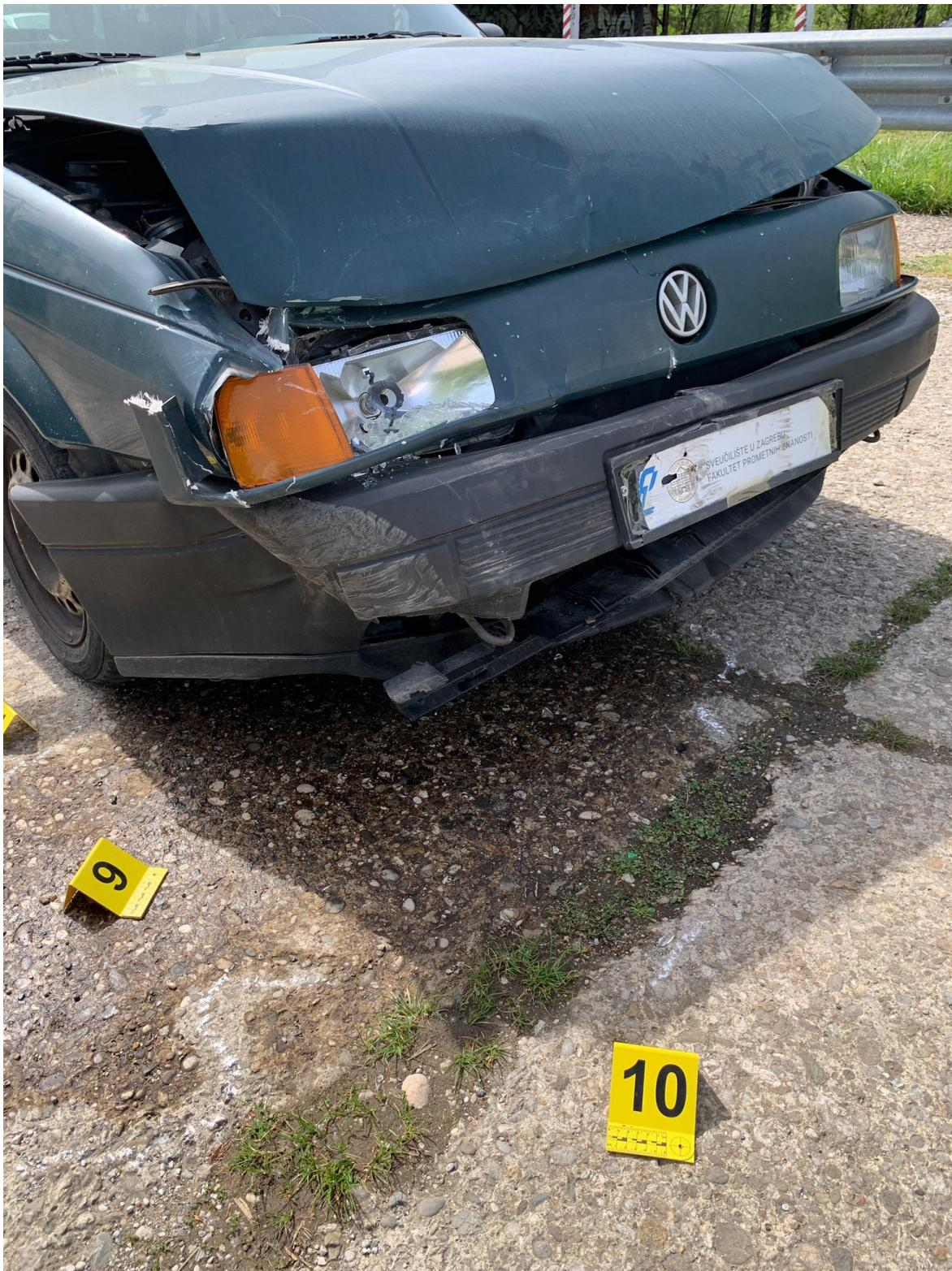
Slika 23. Prikaz oštećenja i deformacije karoserije Volkswagen Passata
