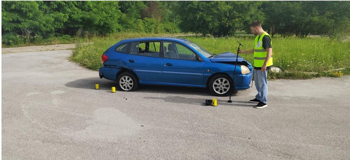
*Slika 32. Prikaz korištenja uređaja za mjerjenje na temelju senzora pokreta, "Moasure One Pro" uređaja*
