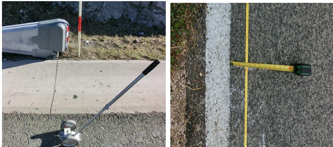
Slika 3. Prikaz mjernih kolica (lijevo) i metra (desno)
