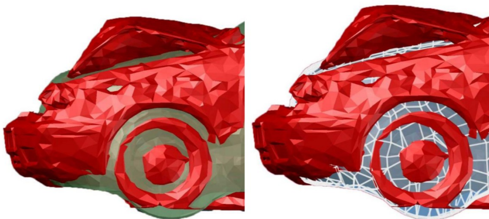
Slika 7. Primjena fotogrametrije u procjeni deformacije vozila [10]
