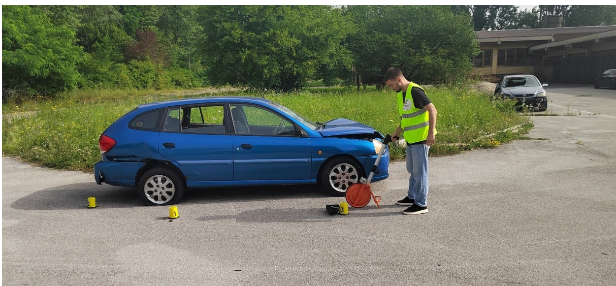
Slika 31. Prikaz korištenja tradicionalnih mjernih kolica
