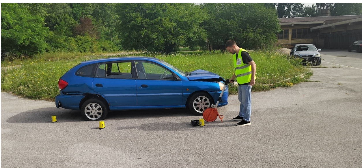
Slika 31. Prikaz korištenja tradicionalnih mjernih kolica
