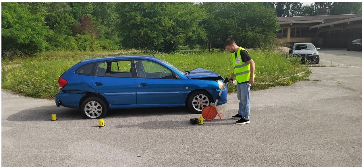
*Slika 31. Prikaz korištenja tradicionalnih mjernih kolica*
