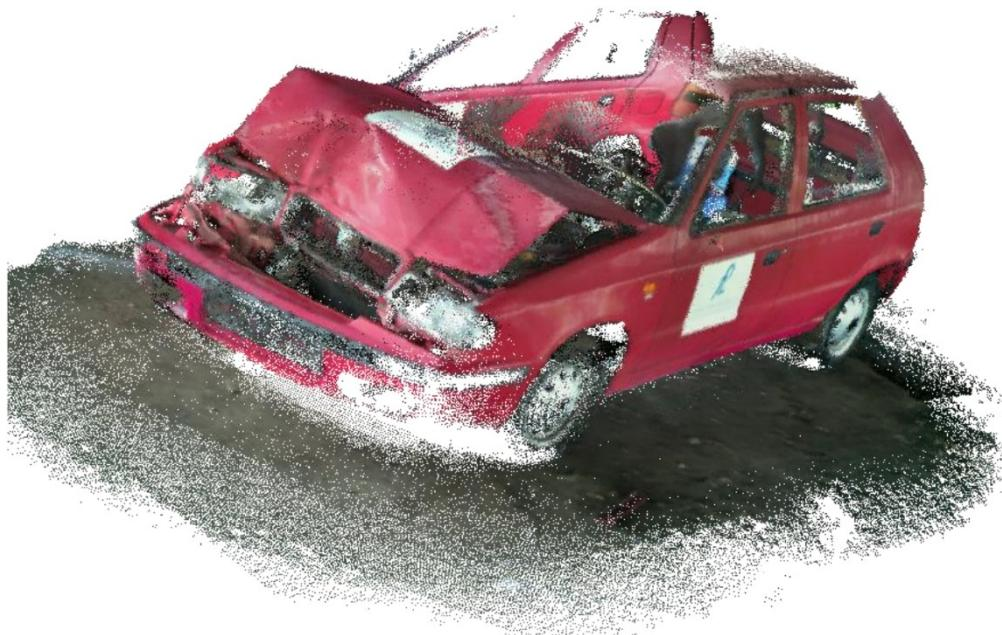
Slika 14. Prikaz 3D modela izrađen pomoću LiDAR kamere [10]
