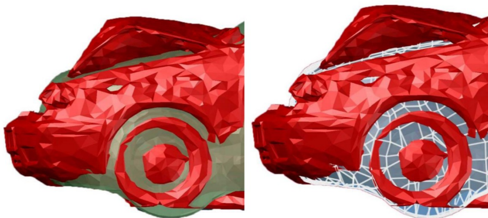
Slika 7. Primjena fotogrametrije u procjeni deformacije vozila [10]
