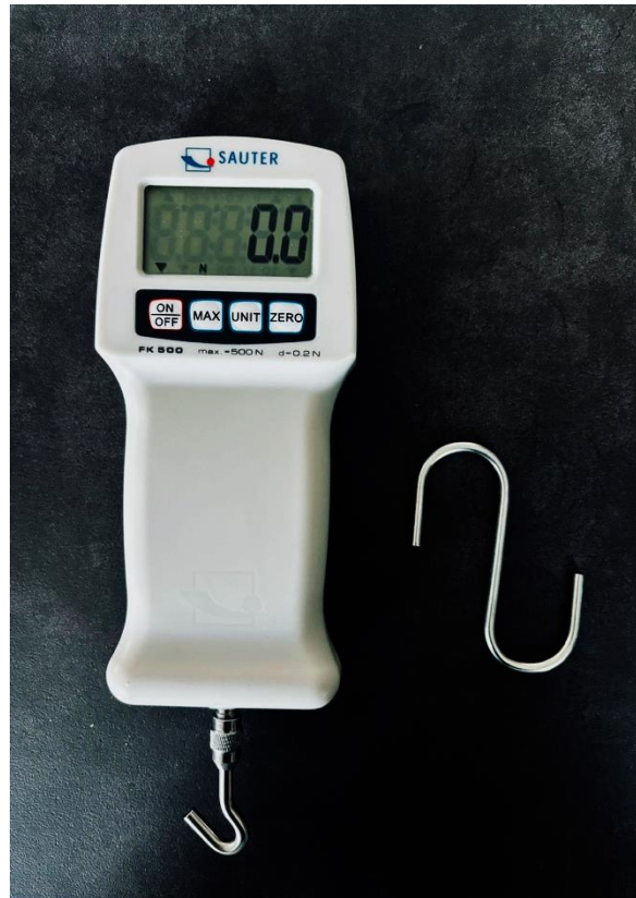
Slika 28. Dinamometar Sauter FK 500
