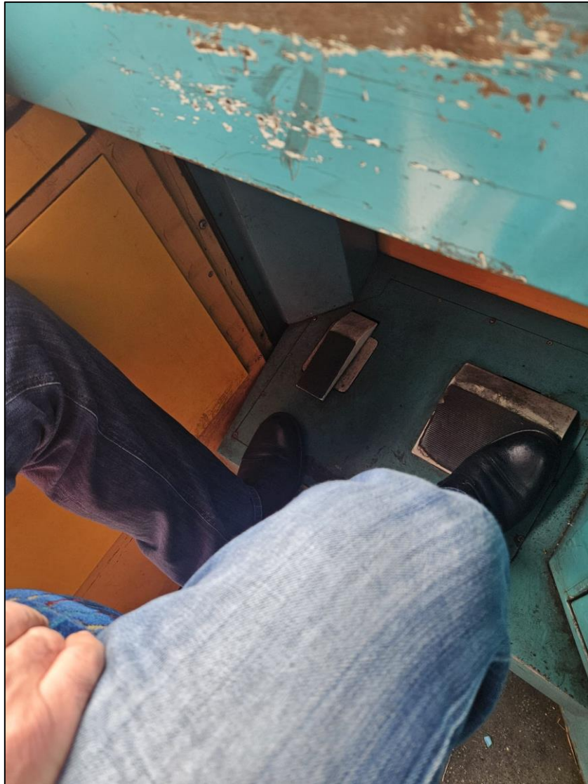
Slika 5. 7 Sirena (lijeva pedala) i budnik (desna pedala)
