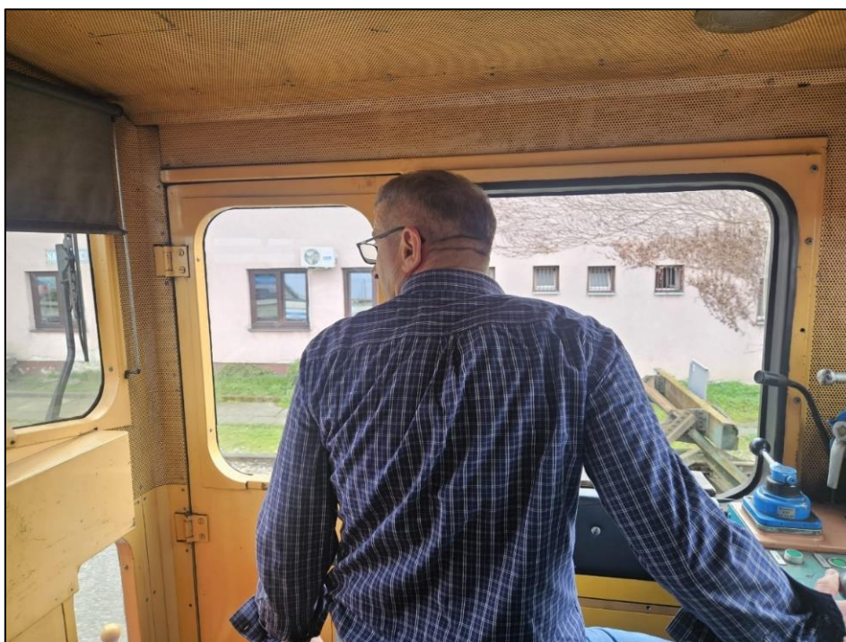
Slika 5. 4 Položaj strojovođe prednjom stranom tijela okrenut prozoru (pogled prema kraćem, odnosno stražnjem dijelu manevarske dizel lokomotive – vožnja unazad)
