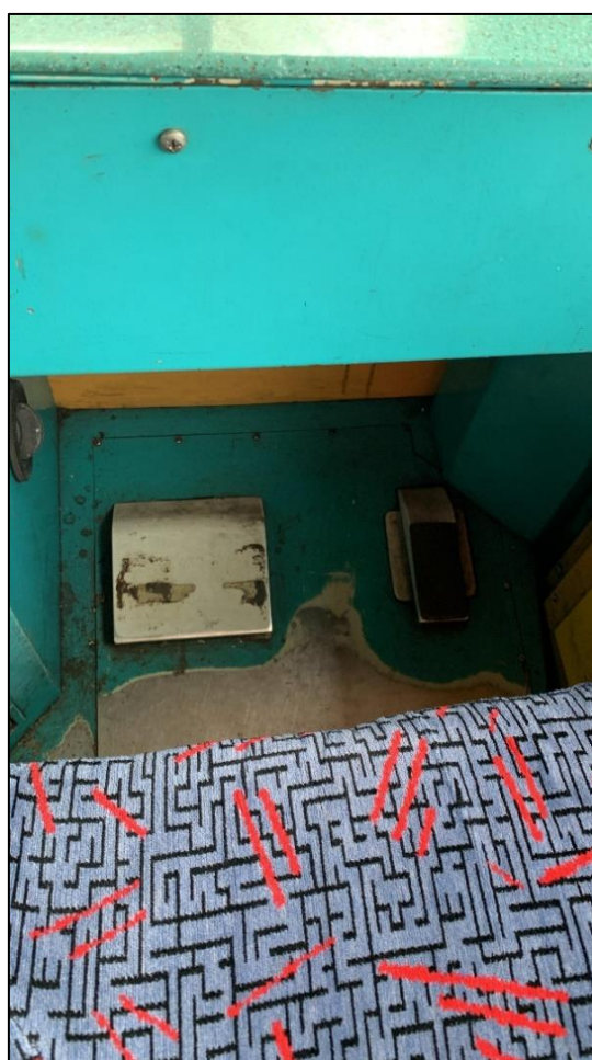
Slika 5. 10 Budnik (lijeva pedala) i sirena (desna pedala) na desnoj strani upravljačnice
