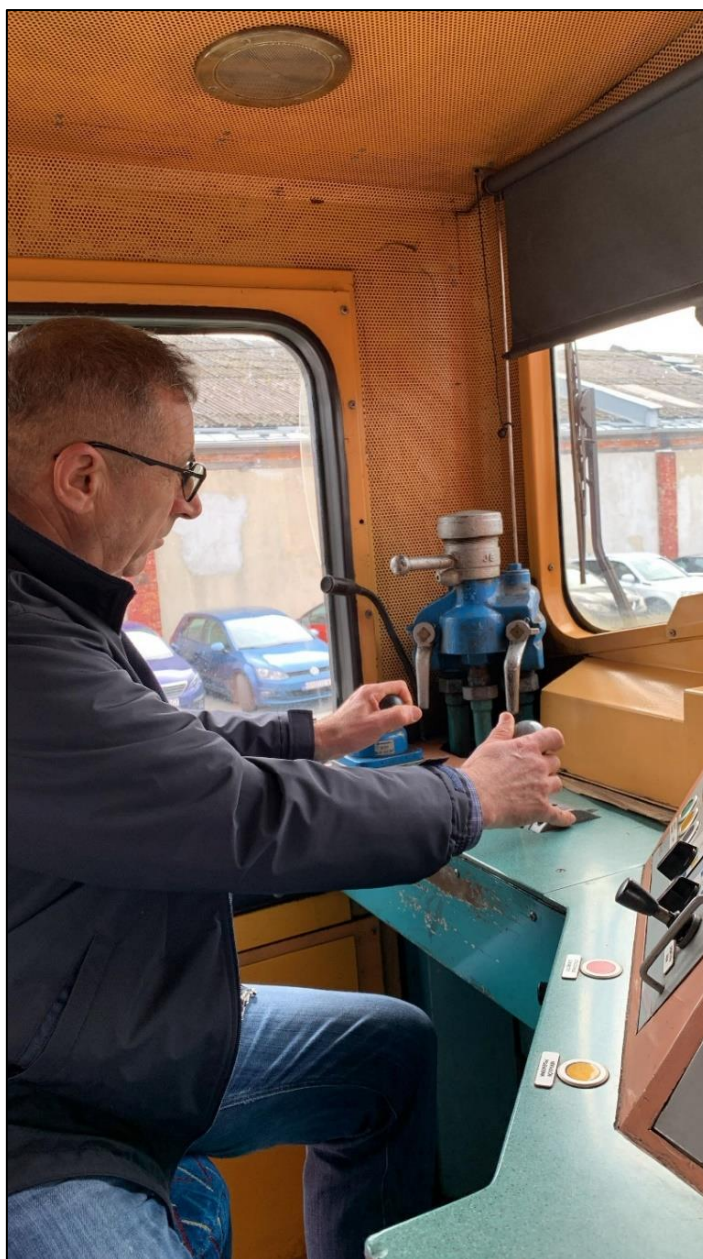
Slika 5. 6 Ruke na kočnici lokomotive, ručici promjene smjera i ručici gasa
