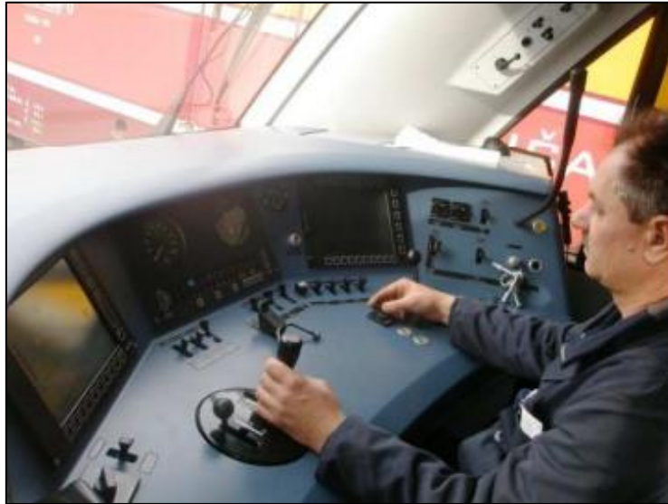
Slika 2. 1 Ergonomijski oblikovana ručica višenamjenskog kontrolera za lijevu ruku strojovođe s rezervnom opcijom tastera za posluživanje budnika palcem lijeve ruke
