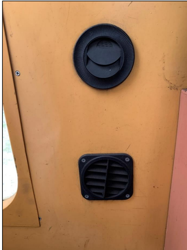
Slika 5. 13 Otvori za grijanje dizel manevarske lokomotive HŽ serije 2132-300
