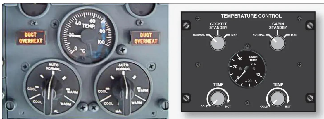
Slika 3.4. Uobičajeni kontrolni sistem temperature za regulaciju temperature velikog mlaznog zrakoplova (lijevo) i poslovnog mlaznog zrakoplova (desno)
