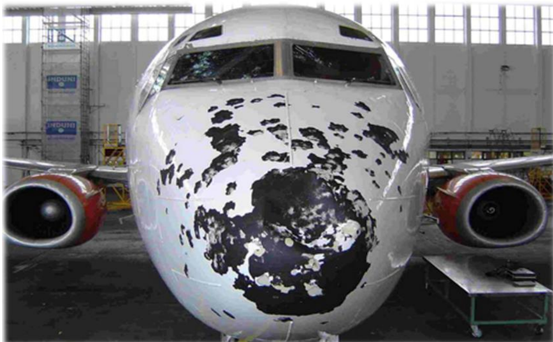
Slika 5. Šteta nastala djelovanjem tuče [10]
