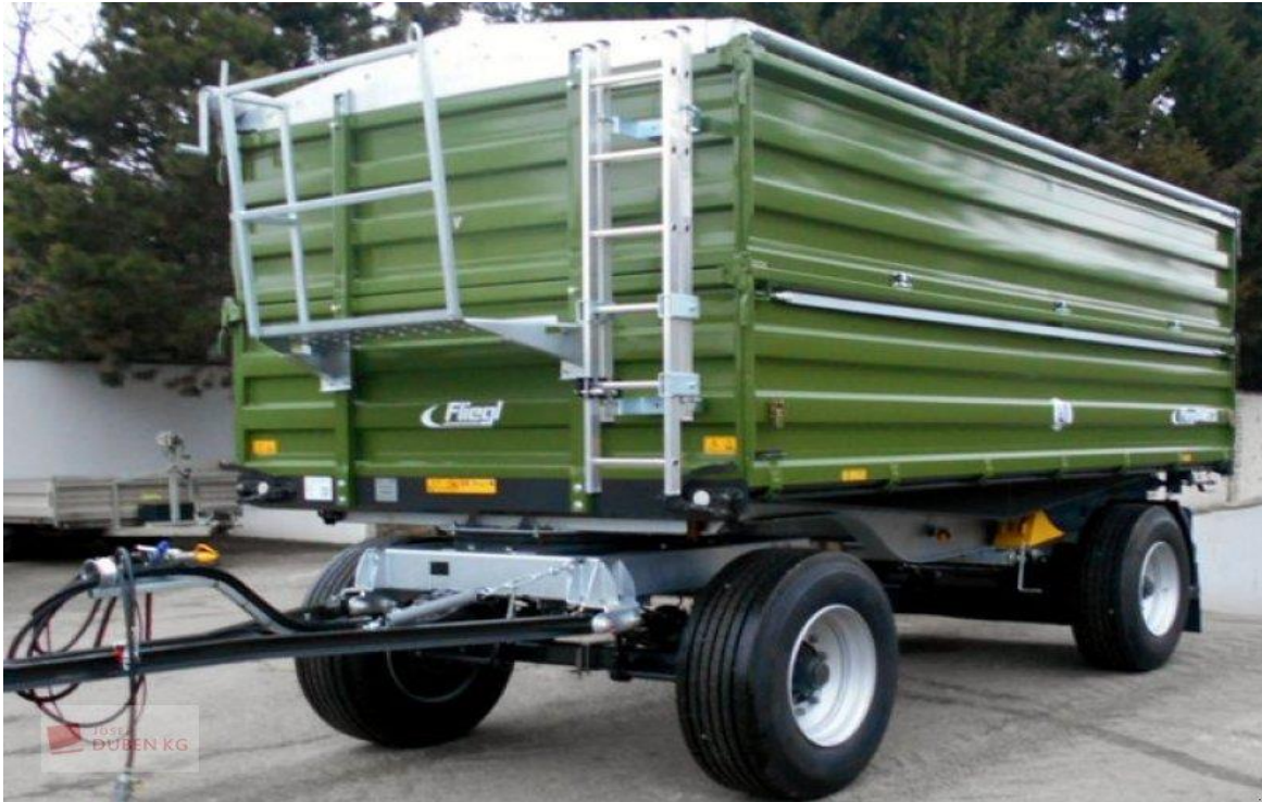
Slika 12. Dvoosovinska upravljiva prikolica
