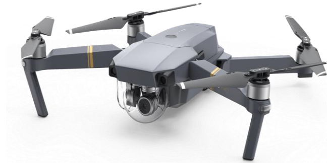
Slika 9. Besposadna letjelica (dron) MAVIC PRO, primijenjena za snimanje videozapisa odabranih segmenata cesta visokoga učinka u Republici Hrvatskoj. Izvor: web -stranica Camera Centre UK 25 .
