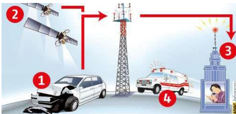
Slika 24: Shematski prikaz E-poziva Izvor: [18]
