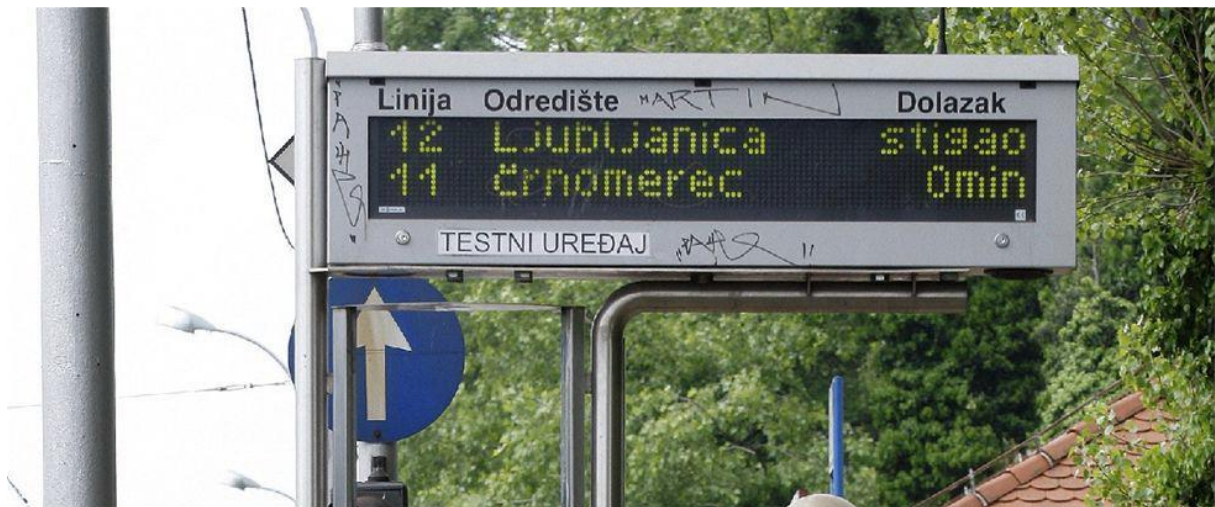
Slika 7. Display informiranja putnika o dolasku vozila na stajalište, [24]
