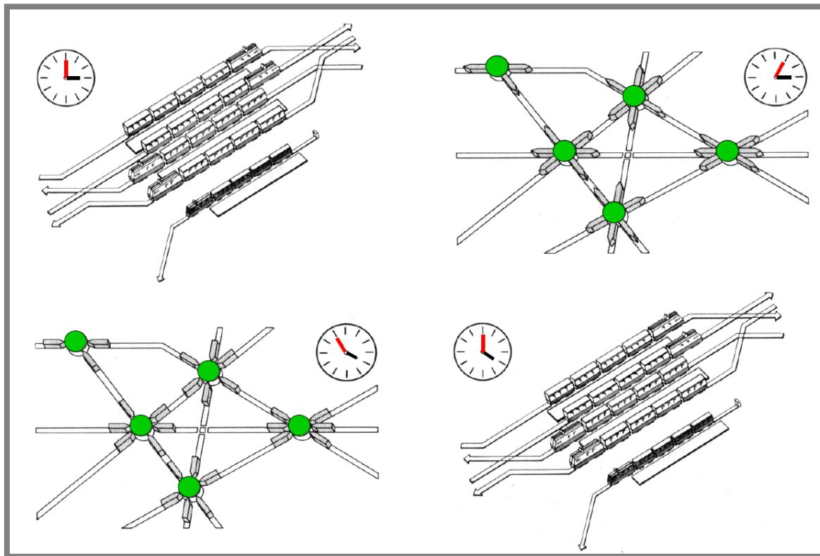
Slika 3.2: Princip integriranog taktnog vozniog reda
