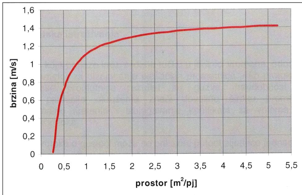
Slika 5.9: Odnos brzine i prostora dobiven mjerjenjem u Zagrebu
