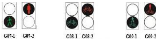
Slika 2. Prometni svjetlosni znakovi za bicikliste i pješake na uređajima za upravljanje prometom [2]
