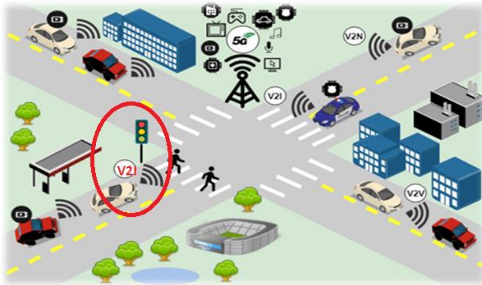
Slika 11. Prikaz razmjene podataka V2I
