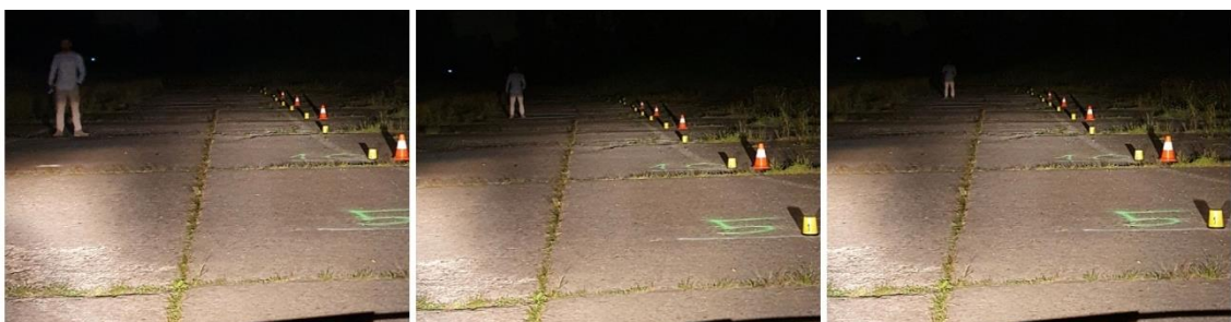
Slika 63. Pješak 2 15m, 30m, 40m lijevo - Fiat Punto 2
