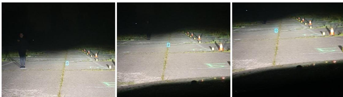
Slika 70. Pješak 1 10m, 20m, 2 m lijevo – Citroen C6
