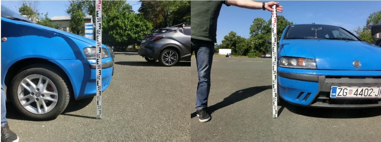
Slika 59. Visina svjetlosnog uređaja Fiat Punto 2
