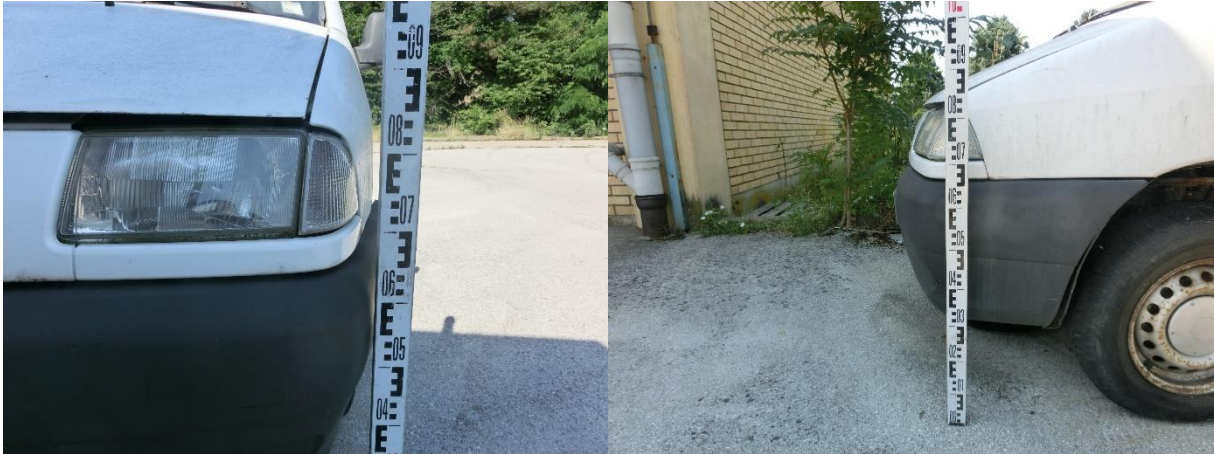
Slika 49. Visina svjetlosnog uređaja Fiat Scudo
