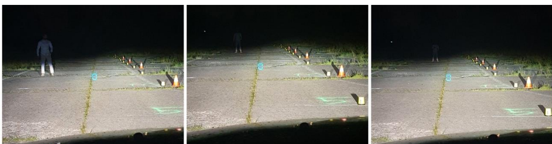
Slika 73. Pješak 2 15m, 30m, 35 m lijevo - Citroen C6
