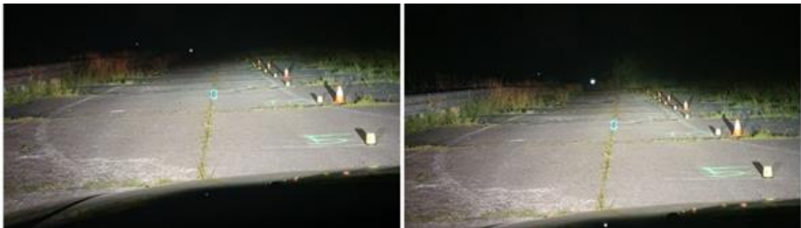
Slika 78. Pješak 3 100m kratko/dugo svjetlo - Citroen C6
