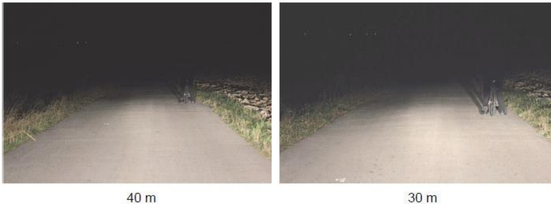
Slika 5. Udaljenost stražnjeg kotača bicikla
