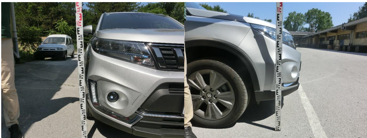
Slika 34. Visina svjetlosnog uređaja Suzuki Vitare
