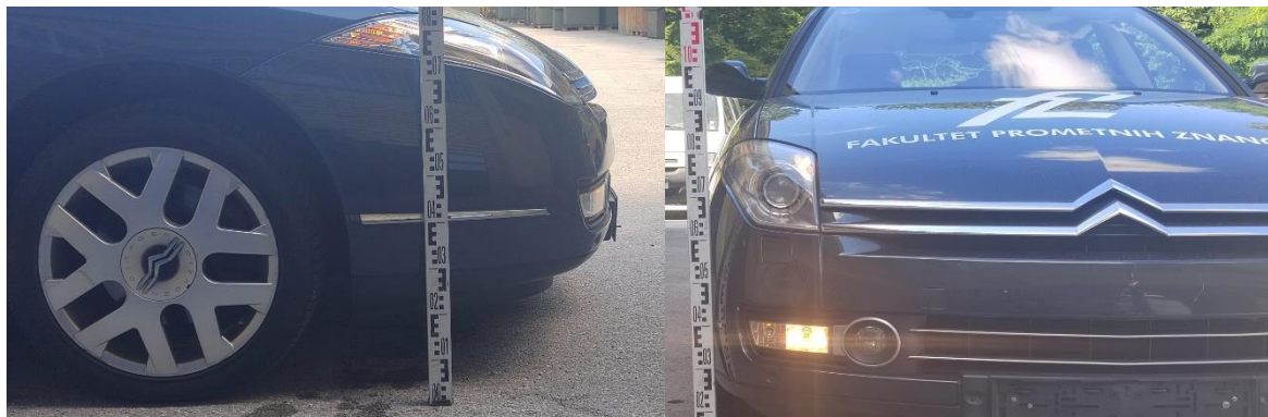
Slika 69. Visina svjetlosnog uređaja Citroena C6
