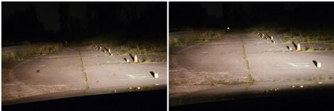
Slika 47. Pješak 1 i 2 na 100m, kratka svjetla - VW Passat 8
