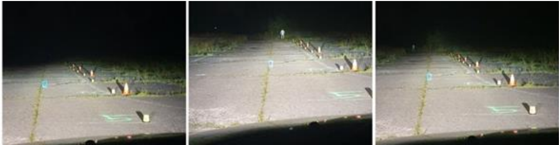
Slika 77. Pješak 2 70m kratko/dugo i 100m dugo svjetlo - Citroen C6
