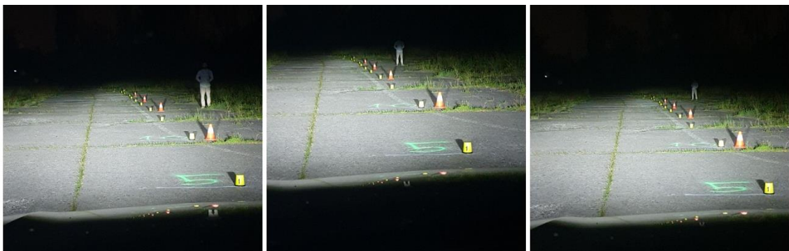
Slika 40. Pješak 2 20m, 35m, 45m desno – Suzuki Vitara
