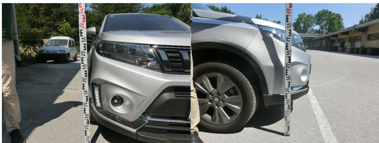
Slika 34. Visina svjetlosnog uređaja Suzuki Vitare
