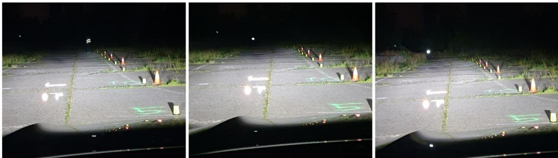
Slika 31. Pješak 3 50 i 100 m kratka, 100m duga svjetla - BMW
