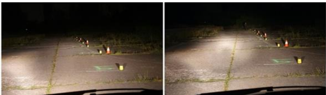
Slika 66. Pješak 1 na 50m kratka/duga svjetla - Fiat Punto 2
