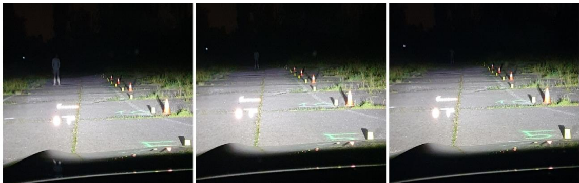
Slika 28. Pješak 2 30m, 40m, 50m, lijevo - BMW
