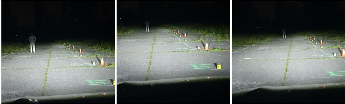
Slika 38. Pješak 2 20m, 3m5, 40m lijevo – Suzuki Vitara
