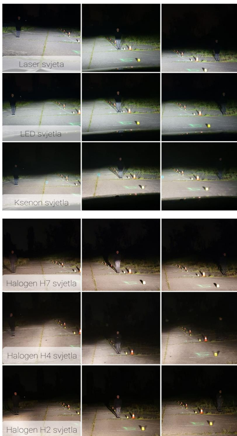
Slika 79. Usporedba svjetlosnih uređaja automobila
