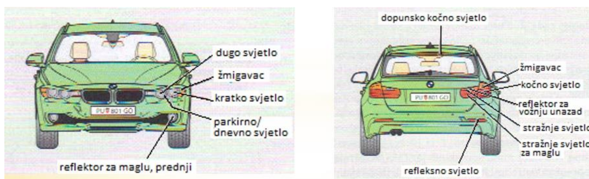
Slika 9. Raspored osvjetljenja vozila
