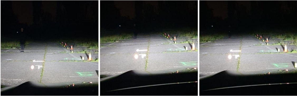
Slika 25. Pješak 1 15m, 25m, 30m lijevo – BMW
