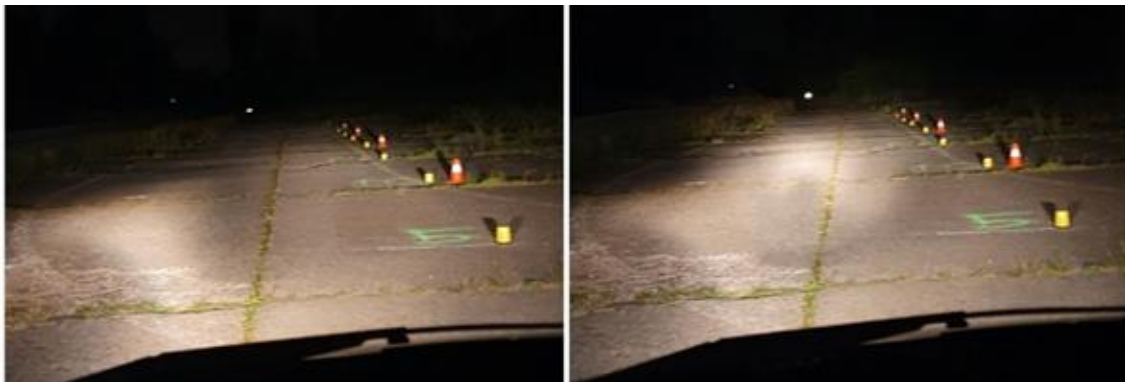
Slika 68. Pješak 3 100m dugo/kratko svjetlo - Fiat Punto 2
