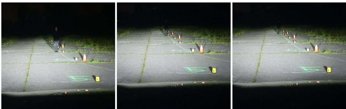
Slika 36. Pješak 1 15m, 25m, 30m uz oznaku – Suzuki Vitara
