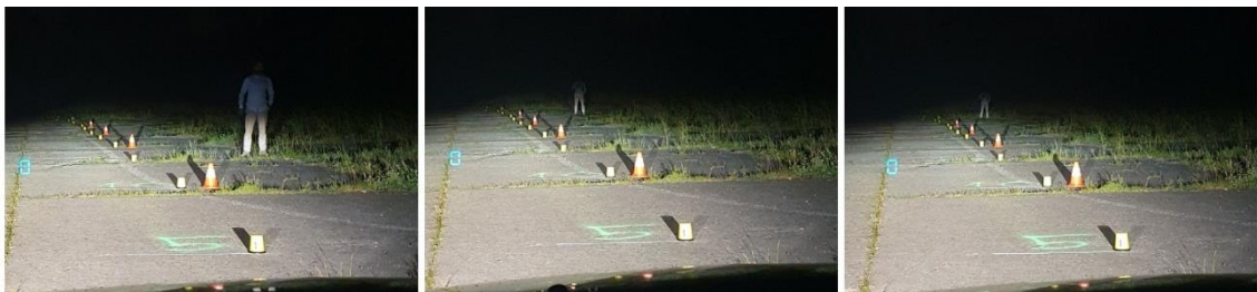
Slika 75. Pješak 2 15m, 45m, 50m desno - Citroen C6
