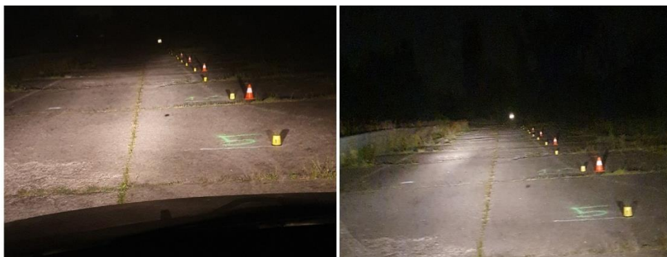
Slika 58. Pješak 3 60m duga/ kratka svjetla - Fiat Scudo
