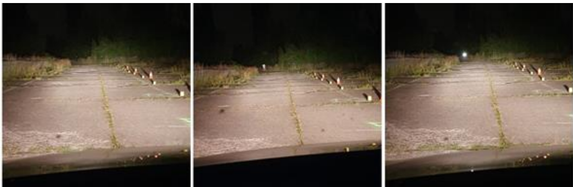
Slika 48. Pješak 1, 2 i 3 na 100m, duga svjetla - VW Passat 8
