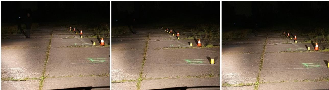
Slika 60. Pješak 1 15m, 20m, 30m lijevo - Fiat Punto 2
