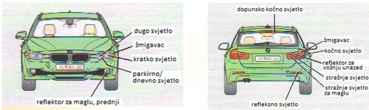
Slika 9. Raspored osvjetljenja vozila
