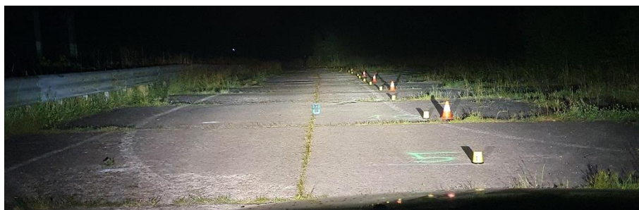
Slika 76. Pješak 1 90m duga svjetla - Citroen C6
