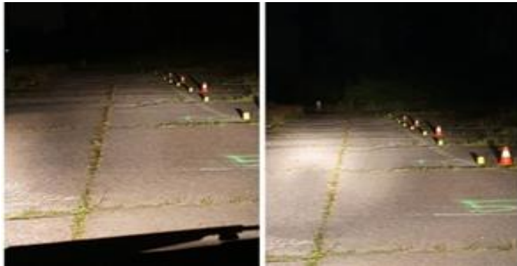
Slika 67. Pješak 2 na 100m kratka/duga svjetla - Fiat Punto 2
