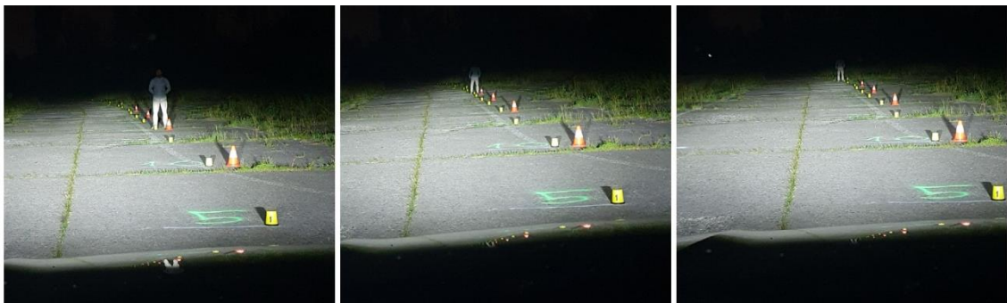
Slika 39. Pješak 2 20m, 40m, 50m uz oznaku – Suzuki Vitara
