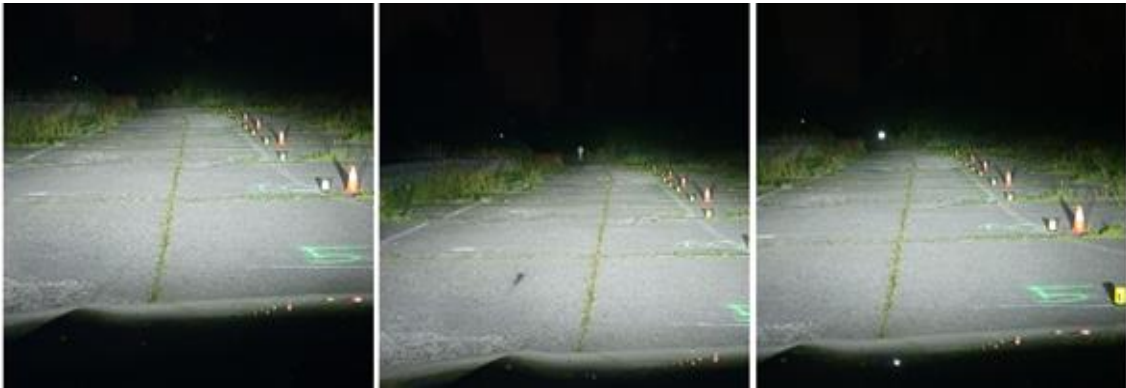
Slika 41. Pješak 1, 2, i 3 na 100m uz oznaku – Suzuki Vitara
