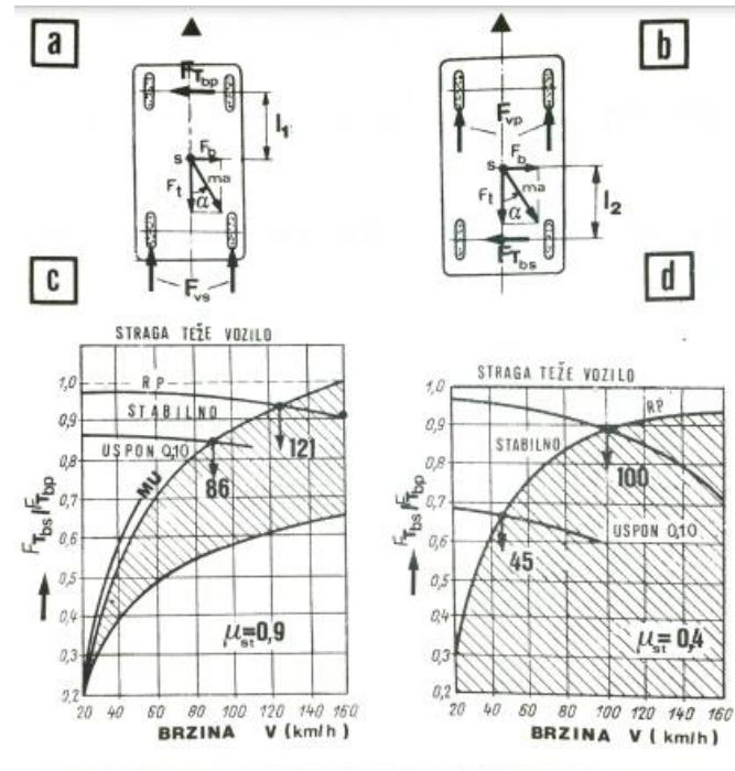
Slika 3: Elementi stabilnosti motornog vozila
