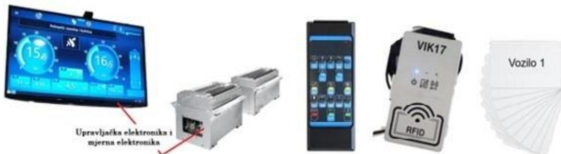
Slika 6. Uređaj za ispitivanje kočica te njegovi dodaci (daljinski upravljač, RFID čitač i kartica). Izvor: [11]
