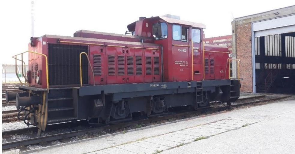
**Slika 11.** Dizel-hidraulična lokomotiva DHL 734-002
