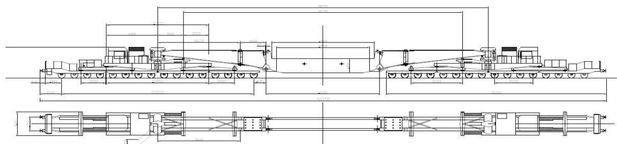
Slika 4. Shema 32 – osovinskog vagona udaljenostima
