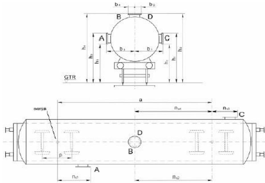
Slika 5. Izvanredna pošiljka s kritičnim točkama i udaljenostima
