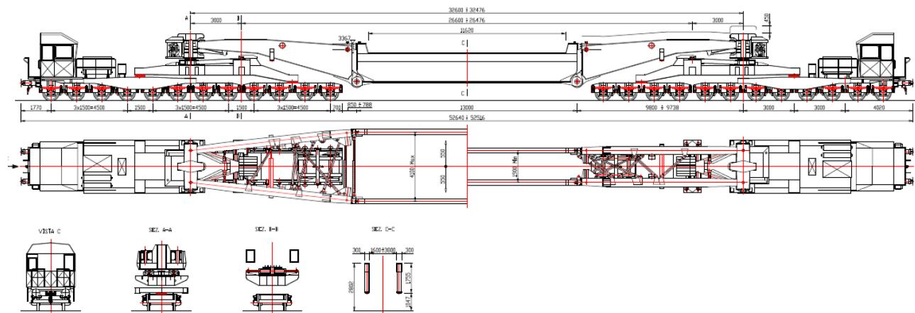
Slika 3. Shema 24 – osovinskog vagona udaljenostima
