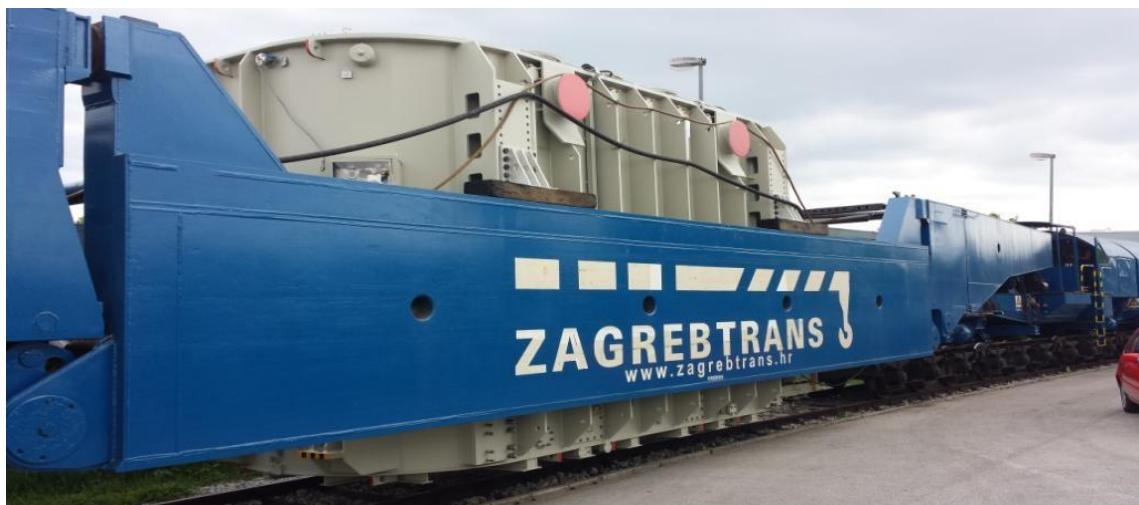
Slika 11. Kotao transformatora na industrijskom kolosijeku Končar
