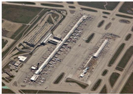
**Slika 4.** Linearna konfiguracija Zračna luka
