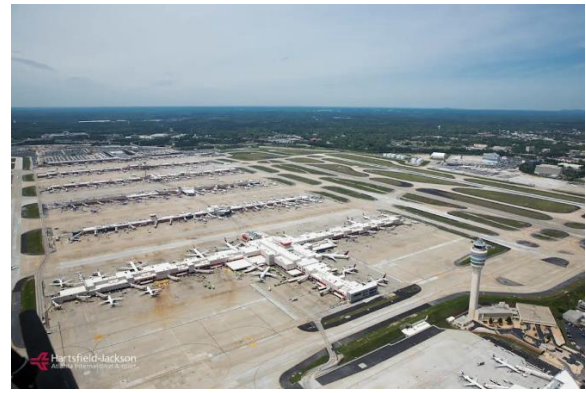
Slika 6. Satelitska konfiguracija Zračna luka Atlanta, SAD, [21]
