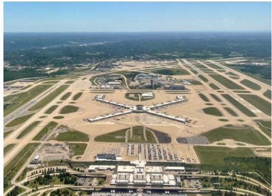
**Slika 7.** Fingerska konfiguracija, X-tip Zračna luka
