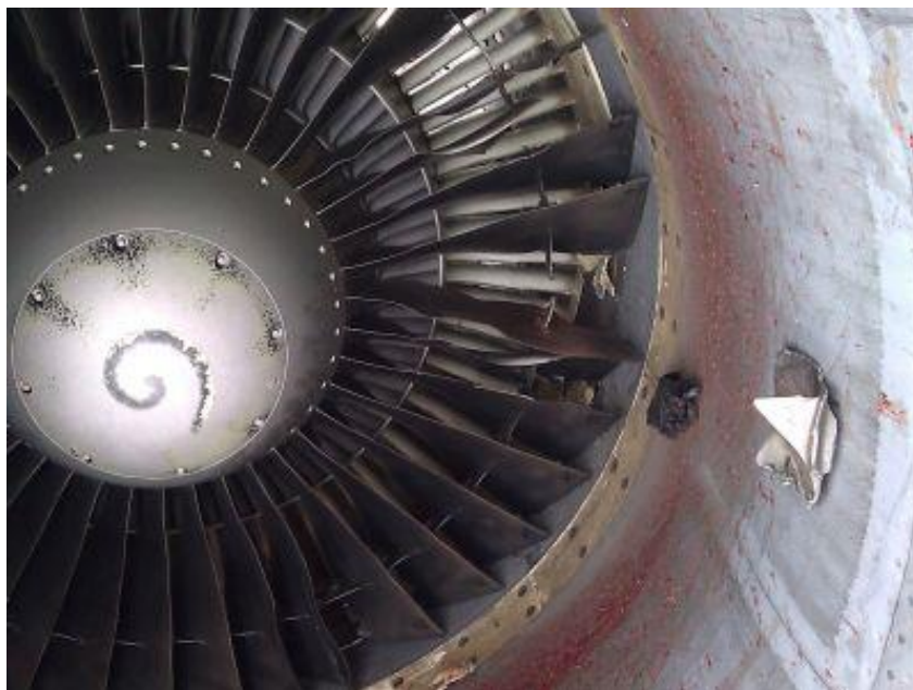
Slika 4. Oštećenje lopatica ventilatora
