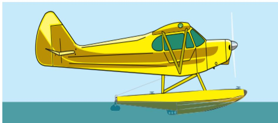
Slika 4. Položaj praznog hoda (hidrozrakoplov se sporo kreće) [2]
