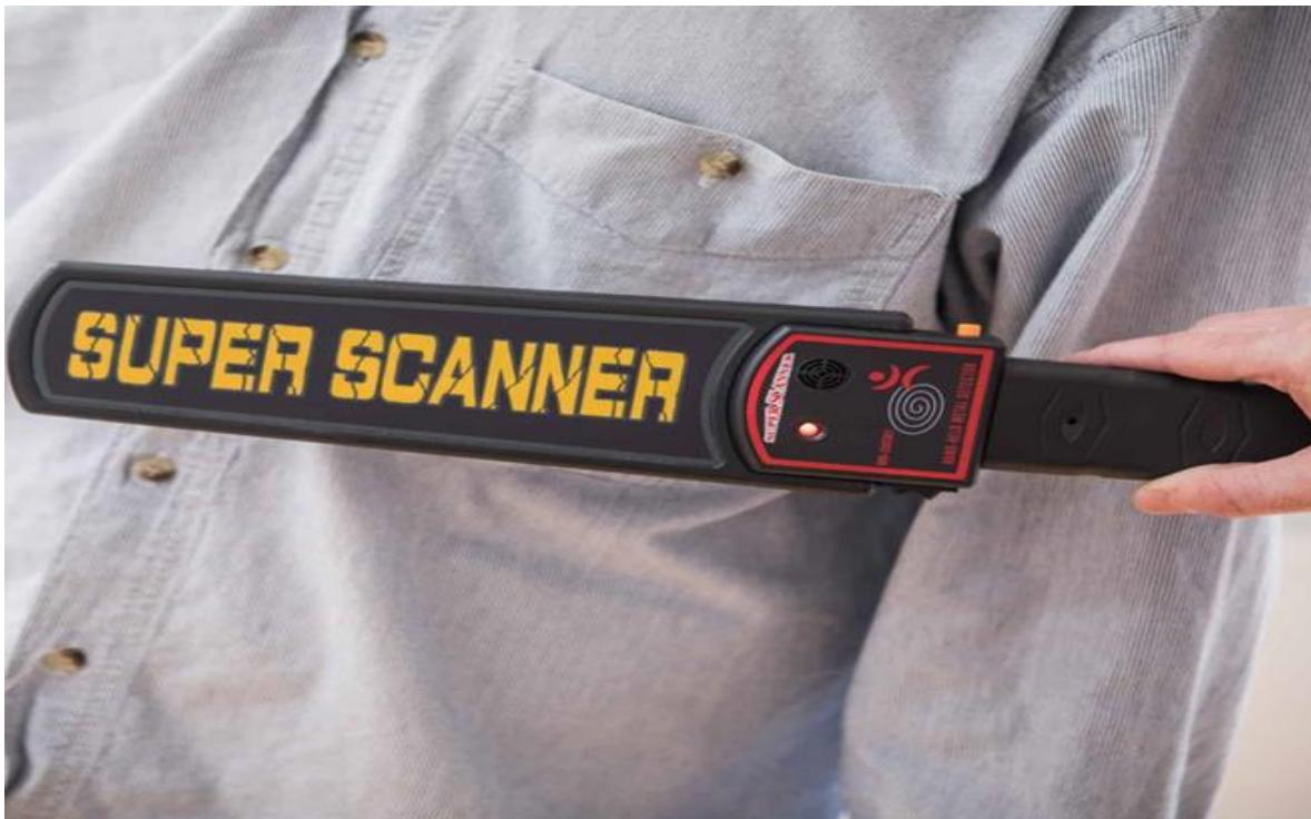
**Slika 17.** Ručni metal detektor
