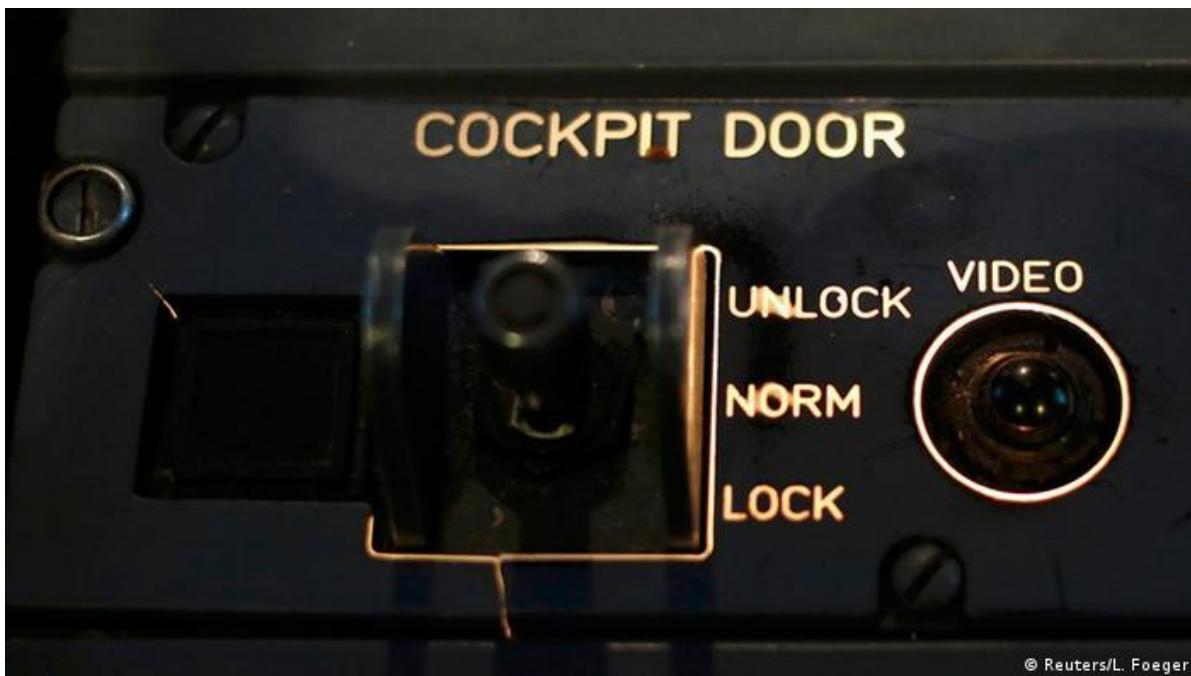
**Slika 21.** Upravljanje neprobojnim vratima u pilotskoj kabini
