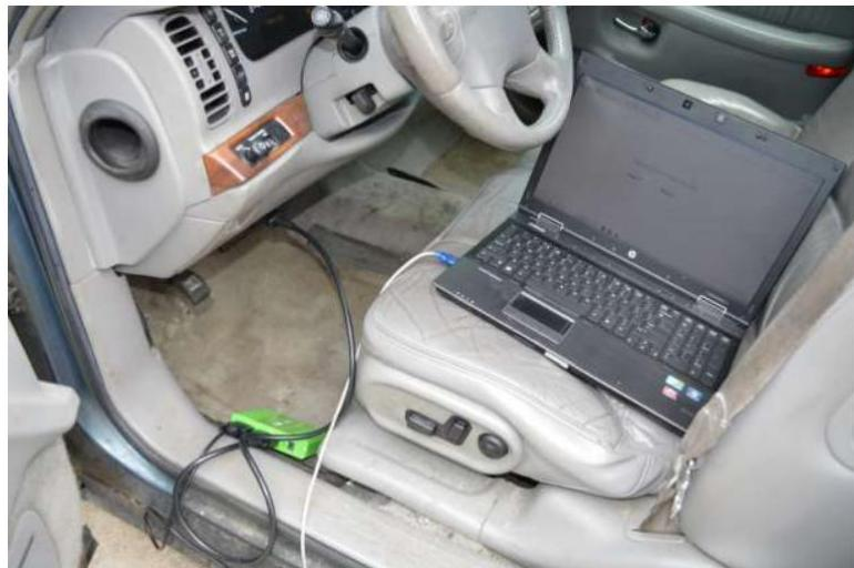
Slika 21. Princip rada metode Direct To Link
