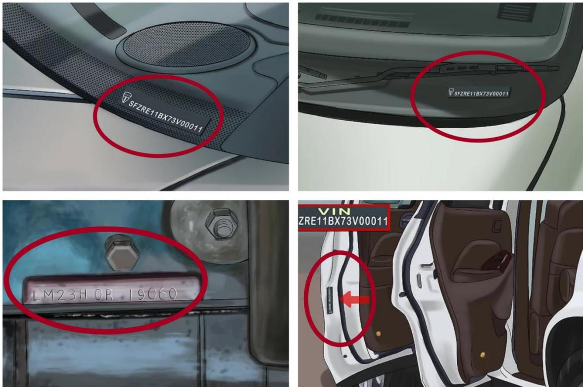
Slika 17. Lociranje oznake VIN na vozilu
