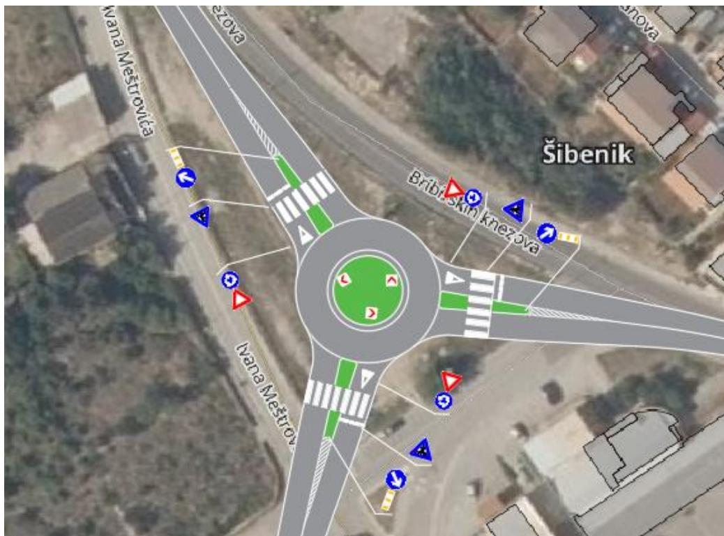
Slika 43. Prikaz rješenja izvedenog raskrižja sa kružnim tokom prometa u AutoCad-u
