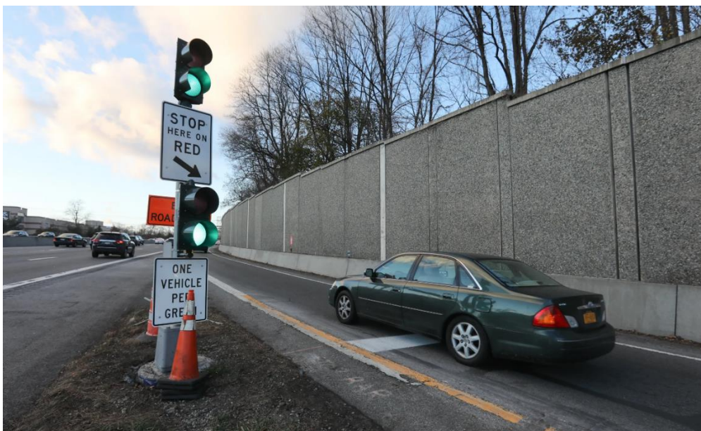
Slika 12. Prikaz upravljanja priljevnim tokom
