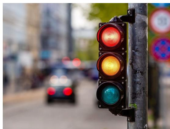
Slika 10. Svjetla na semaforu postavljena po okomitoj osi
