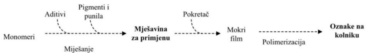
Slika 9. Shema procesa izvođenja hladne plastike [2]
