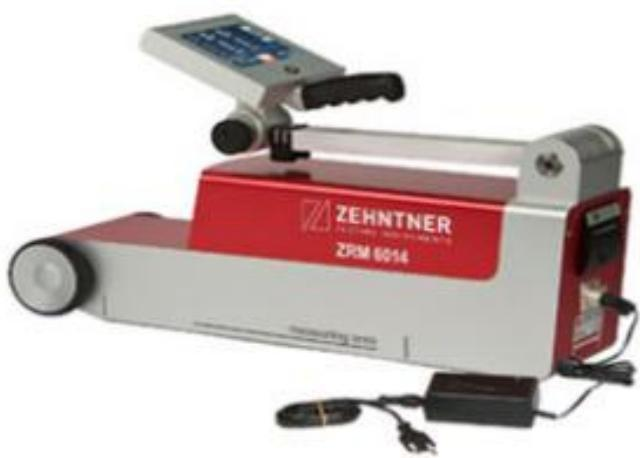
Slika 17. Uređaj za mjerjenje retrorefleksije po statičkim metodama [2]
