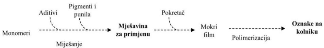
Slika 7. Shema procesa izvođenja termoplastike [signalizacija]
