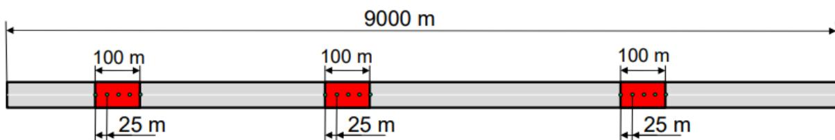
Slika 18. Točke ispitivanja po ZTV MO 2 metodi [2]
