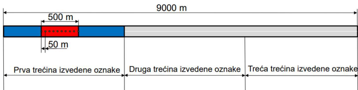
Slika 16. Točke ispitivanja po „Kentucky“ metodi [2]
