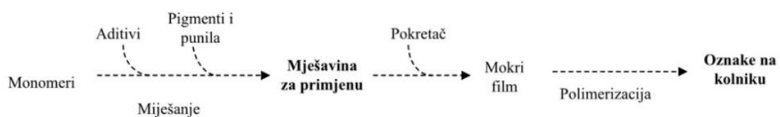
Slika 7. Shema procesa izvođenja termoplastike [signalizacija]
