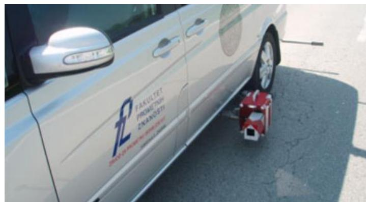
Slika 20. Uredaj za dinamičko mjerjenje postavljen na vozilu za dinamička mjerena [2]
