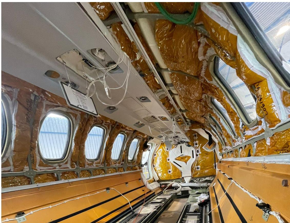
*Slika 5. Tehničke mjere za umanjene buke kabine zrakoplova CJ2 (autorska fotografija)*
