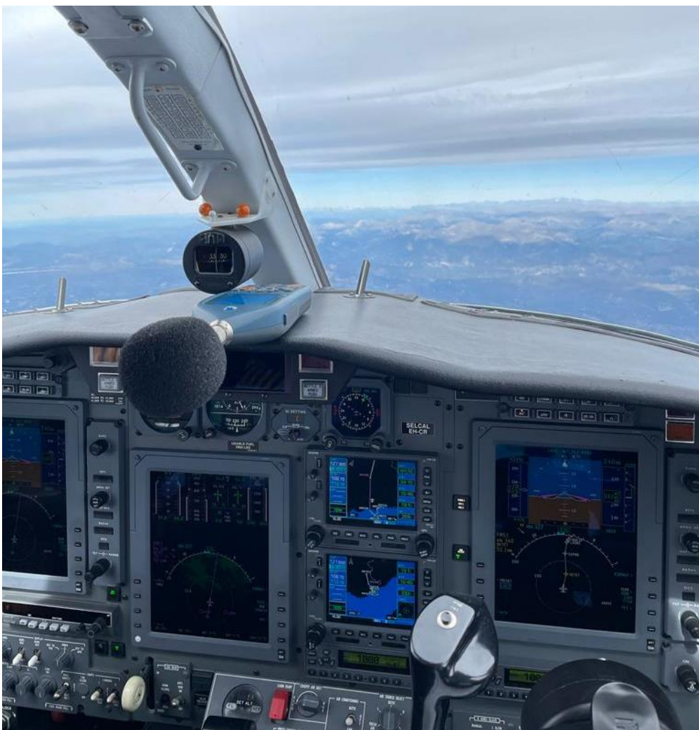
Slika 11. Mjerenje unutarnje buke kokpita zrakoplova Cessna CJ2 (autorska fotografija)
