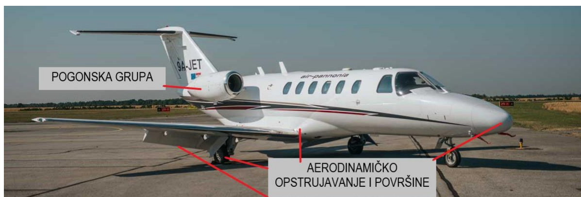
Slika 10. Podjela izvora buke zrakoplova CJ2 (autorska fotografija)
