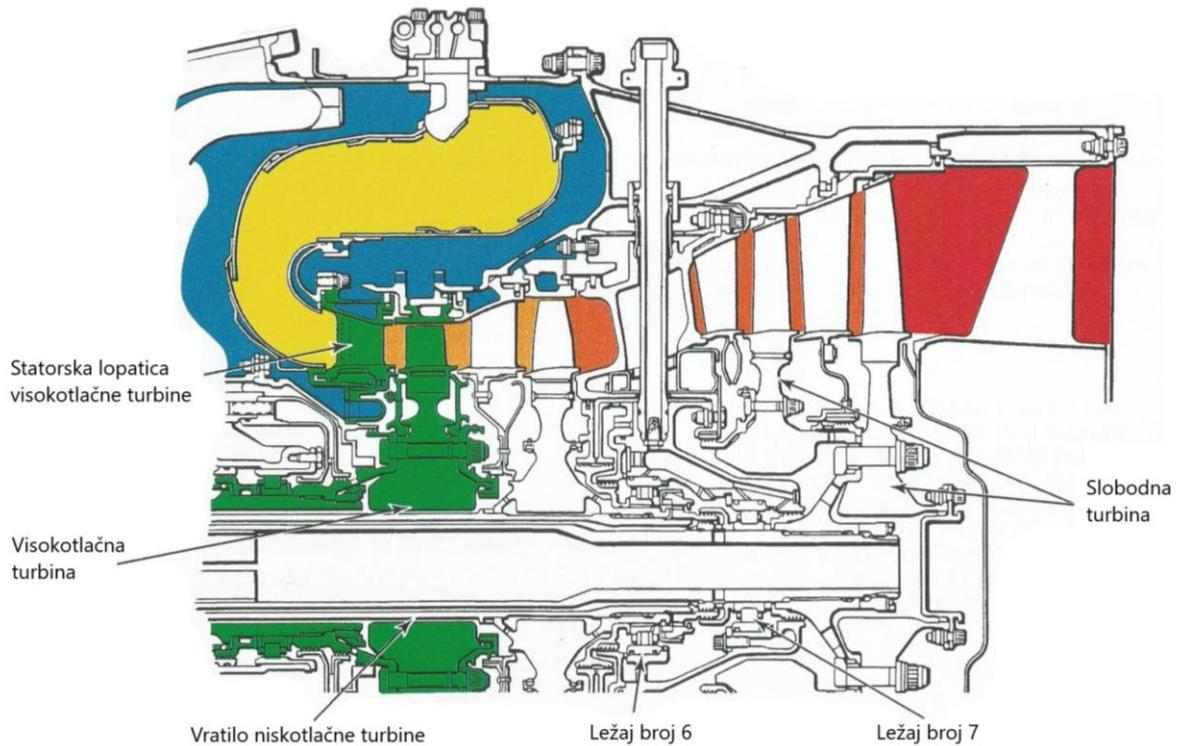
Slika 9: Prikaz visokotlačne turbine [5]
