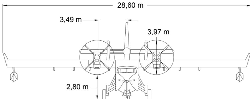
Slika 13: Smještaj motora P&W123AF na zrakoplovu Canadair CL-415 [7]
