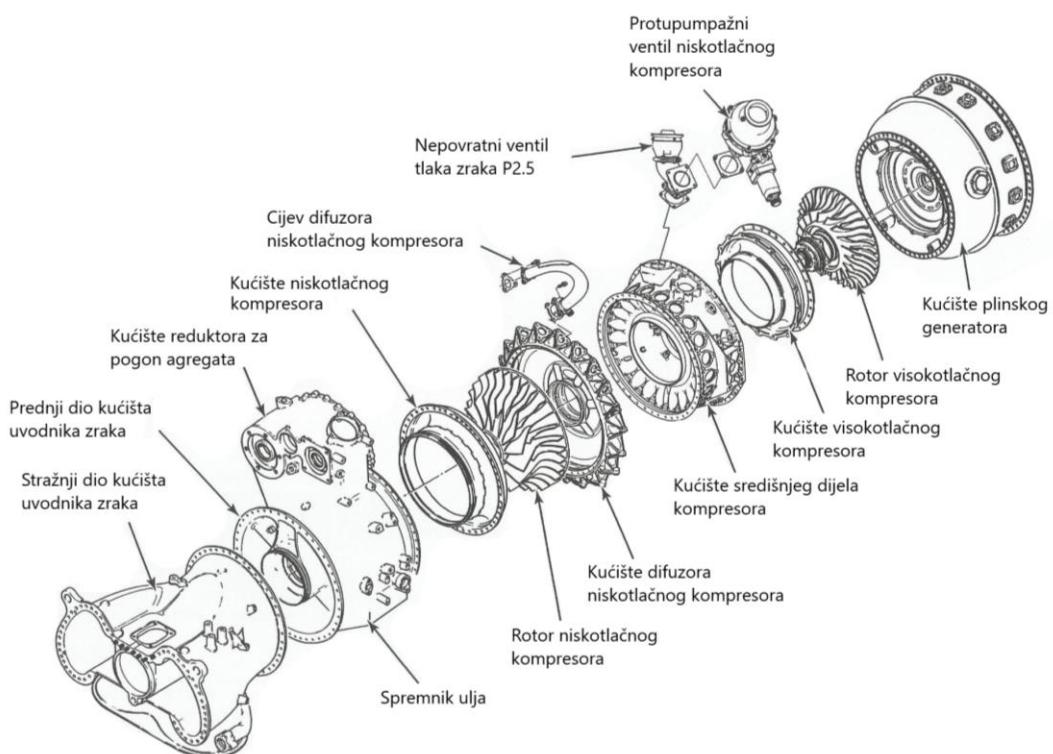
Slika 6: Prikaz uvodnika zraka i kompresora motora P&W123AF [5]
