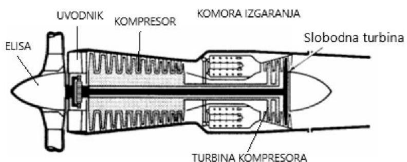
Slika 3: Turbo-elisni motor sa slobodnom turbinom [1]
