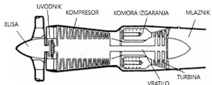
Slika 2: Turbo-elisni motor s direktnim pogonom elise [1]
