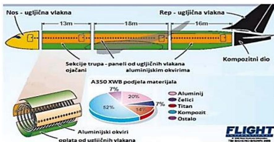
Slika 12. Konstrukcijski materijal zrakoplova Airbus A350 XWB
