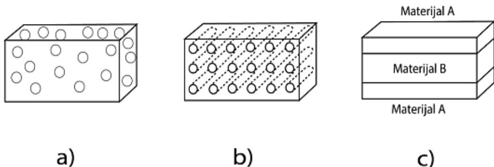
Slika 1. Osnovni tipovi kompozita: (a) kompoziti s česticama; (b) kompoziti s vlaknima; (c) slojeviti kompoziti
