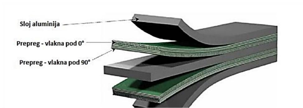
Slika 3. Kompozitni materijal GLARE
