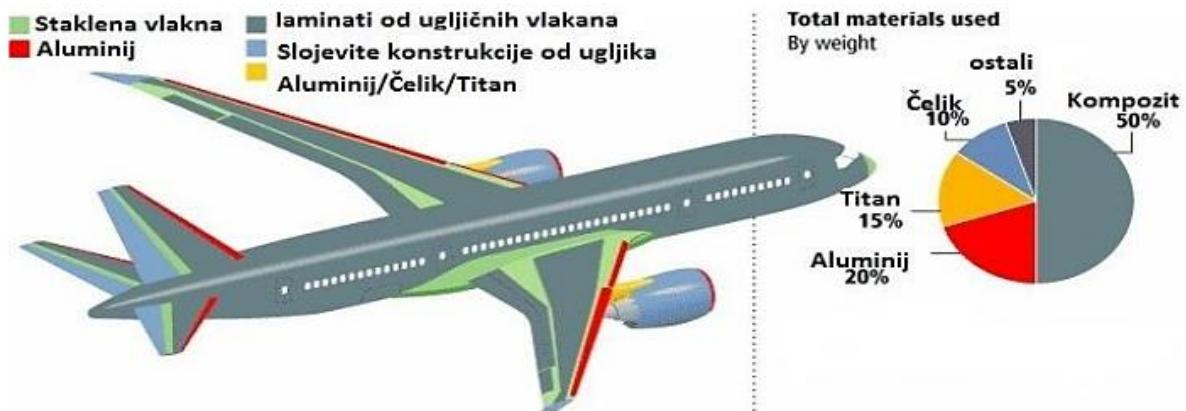
Slika 14. Materijali korišteni na zrakoplovu Boeing 787 Dreamliner
