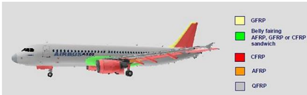
Slika 8. Temeljna svojstva ugljičnih, staklenih, aramidnih vlakana i vlakana od kvarca na zrakoplovu A320
