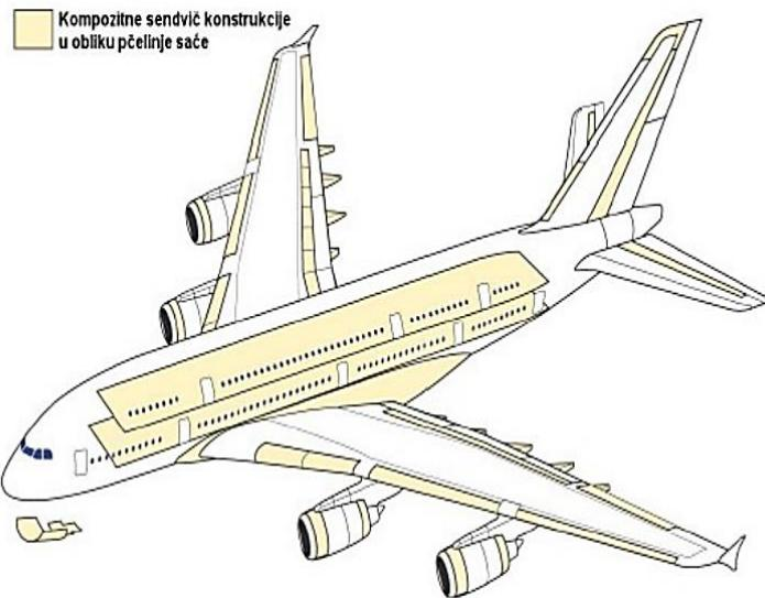
Slika 7. Dijelovi sendvič konstrukcije u obliku pčelinje sače na zrakoplovu Airbus A380
