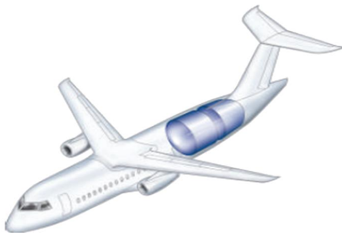
Slika 17. Položaj spremnika vodika kod regionalnih zrakoplova, [50]
