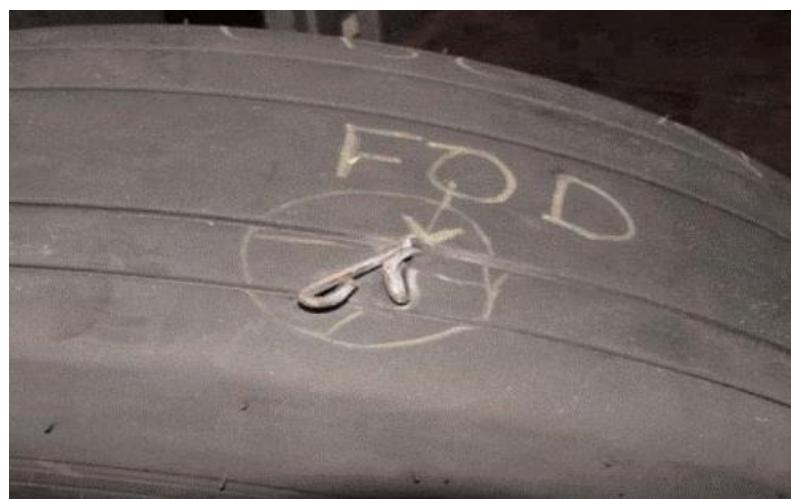
Slika 9. Oštećenje gume, [10]
