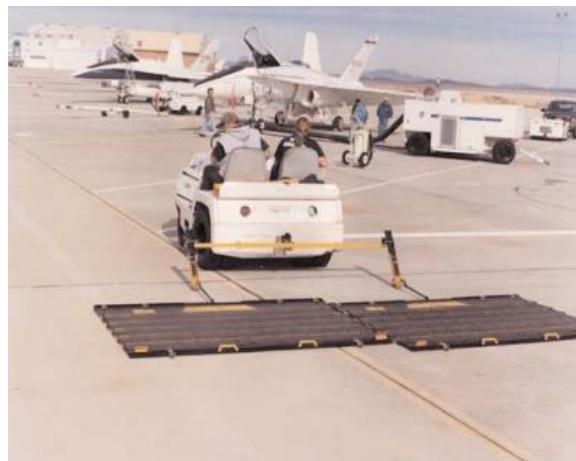
**Slika 15.** Prostirka za uklanjanje FOD-a, [10]
