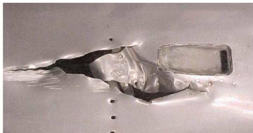
Slika 8. Oštećenje trupa zrakoplova, [10]
