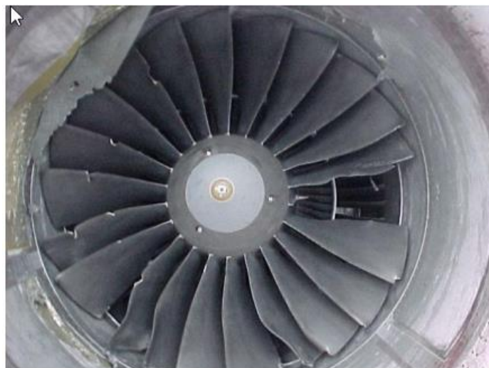
Slika 3. Oštećenje motora zrakoplova prilikom udara ptice, [7]
