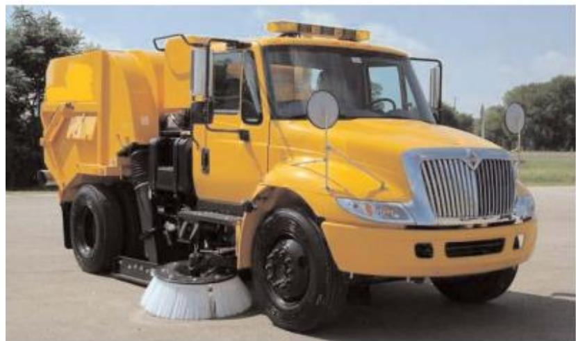
**Slika 18.** Vozilo s četkom i vakuumskim sustavom, [10]
