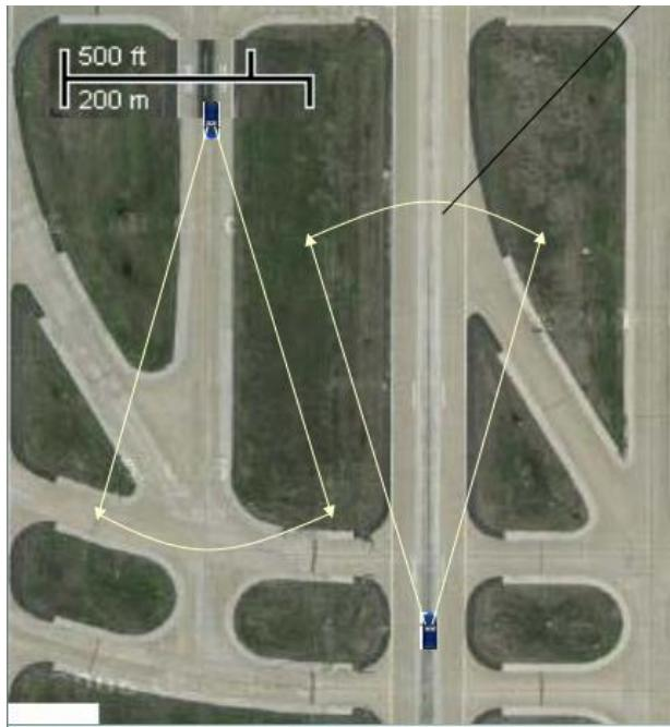
**Slika 11.** Polje skeniranja mobilnih radarskih sustava, [11]
