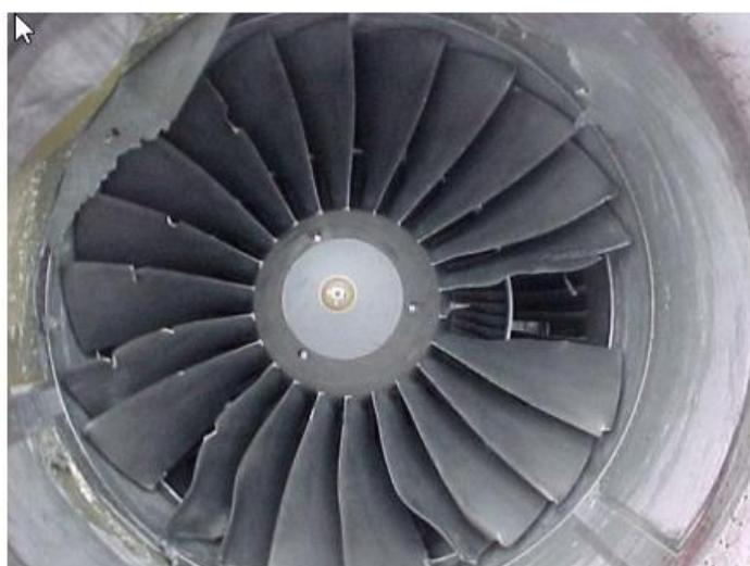
**Slika 3.** Oštećenje motora zrakoplova prilikom udara ptice, [7]
