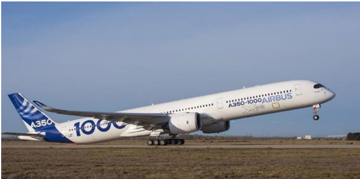
Slika 6. Povlačenje palice prije dostizanja V_{MU} na primjeru zrakoplova Airbus A350-1000, [11]
