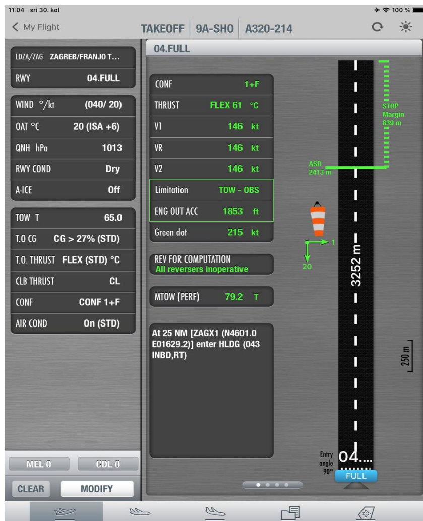
Slika 16. Primjer izračunate temperature i karakterističnih brzina, [14]
