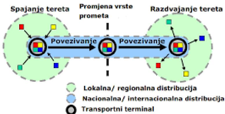
Slika 7. Primjer intermodalnog transportnog lanca<sup>36</sup>
