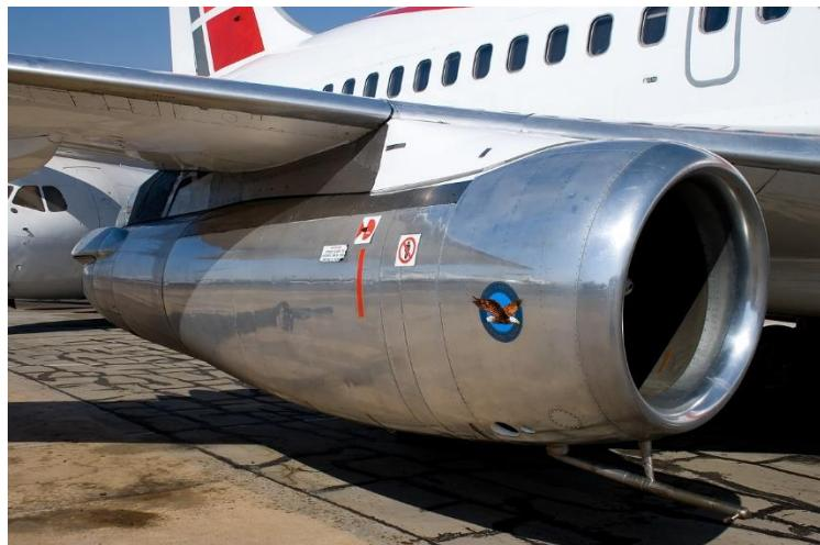
*Slika 2. motor JT8D s opremom za šljunčane staze, [6]*
