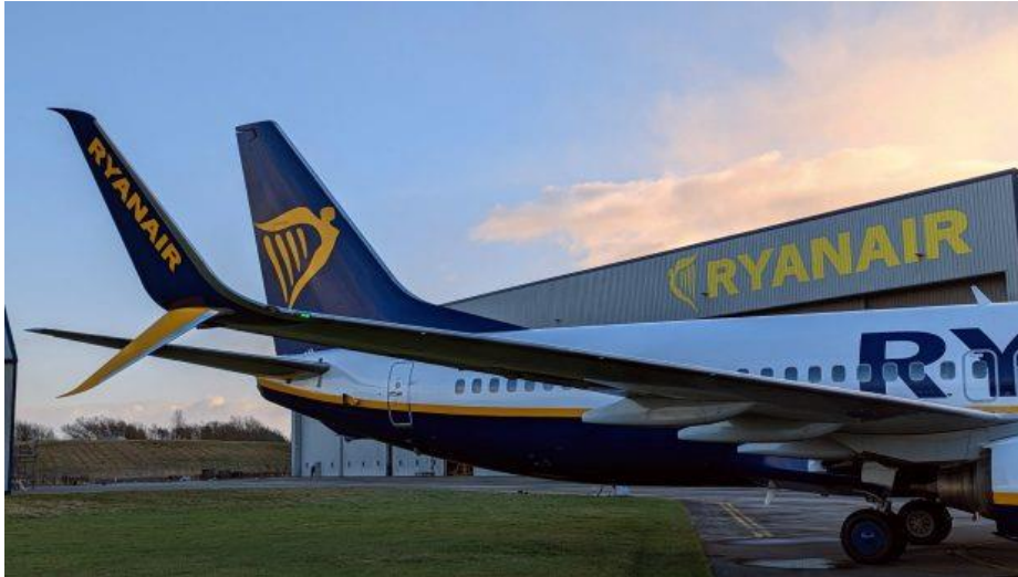
Slika 5. razdvojeni završetak krila (engl. Split Scimitar Winglet), [7]
