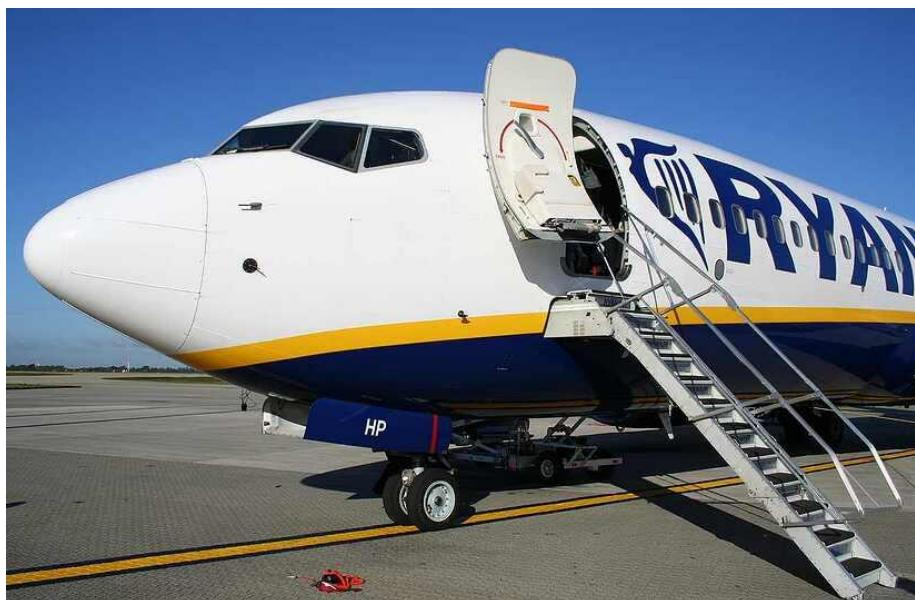
Slika 1. zrakoplov Ryanair-a s ugrađenim stepenicama, [5]
