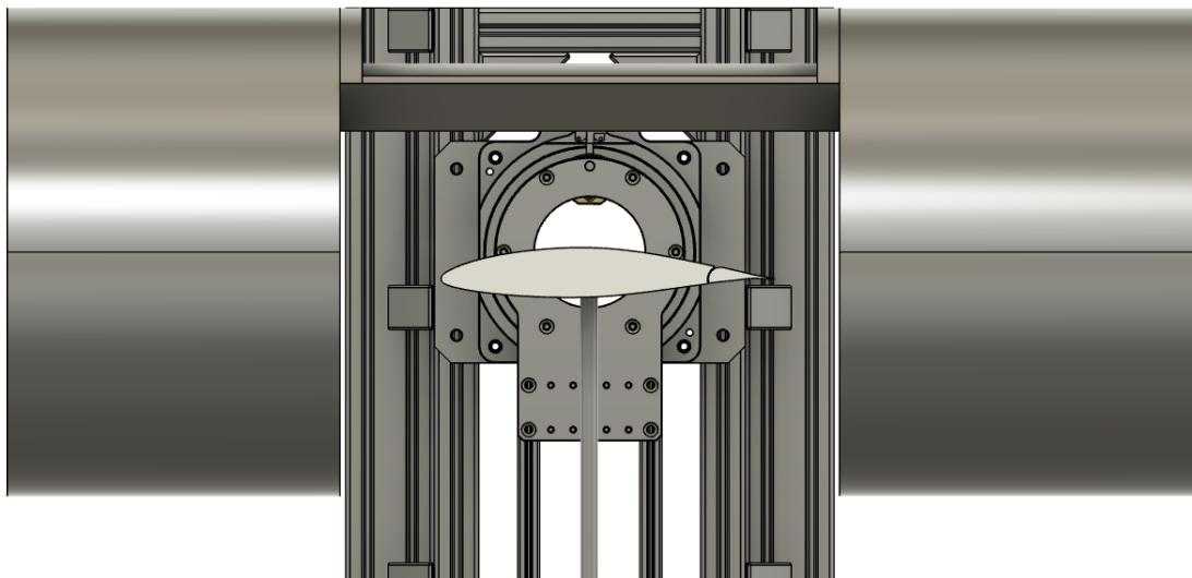
Slika 6: Bočni prikaz NACA 65(2)-415 modela u ispitnoj sekciji
