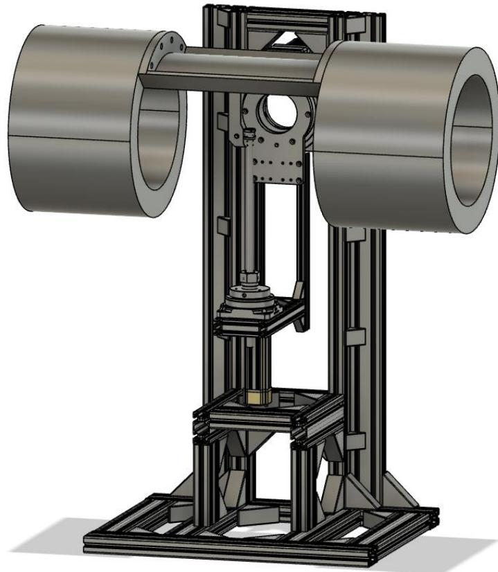
*Slika 1: Ispitna sekcija zračnog tunela te sustav za mjerjenje i prihvatanje modela*
