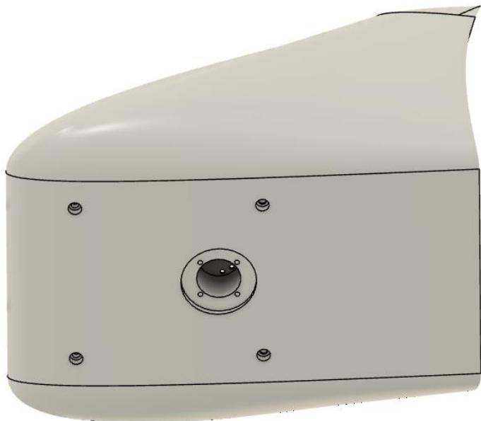
Slika 20: Prikaz ulaza za dinamometar unutar modela
