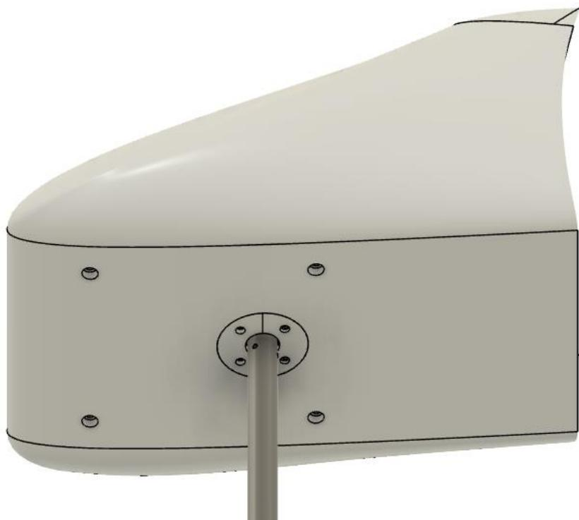
*Slika 23: Primjer ugrađenog modela aeroprofila*
