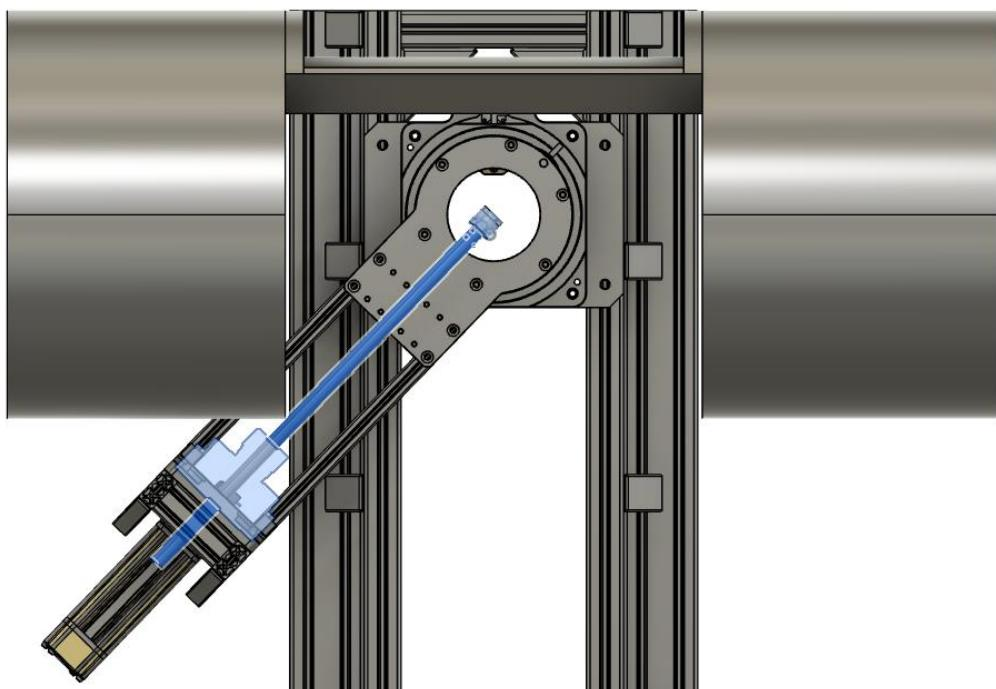
Slika 26: Pomična konstrukcija pod kutom od 44 stupnja
