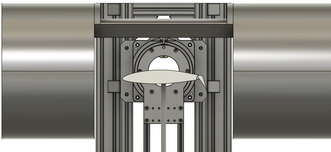
Slika 7: Bočni prikaz NACA 65(2)-415 modela sa spuštenim zakrilcem
