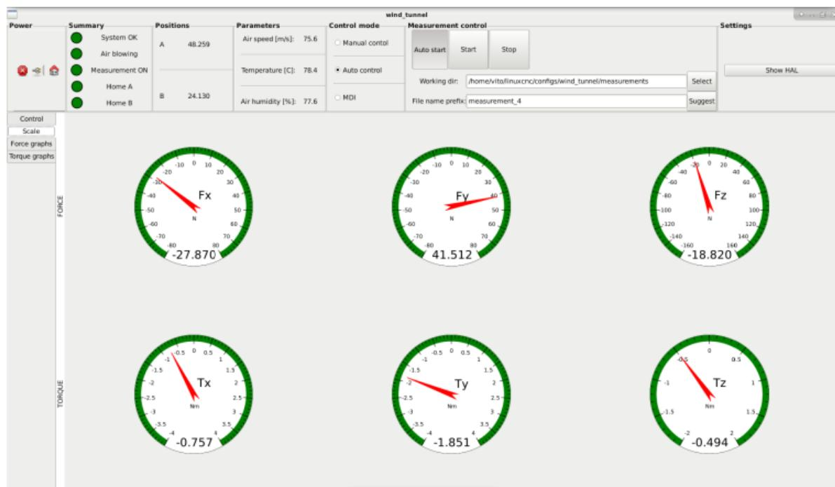
Slika 33: Primjer prikaza mjernih rezultata pomoću kazaljka [1]
