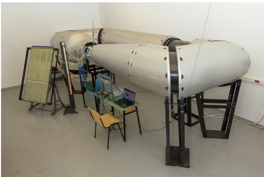
Slika 25: AT-1 zračni tunel [9]
