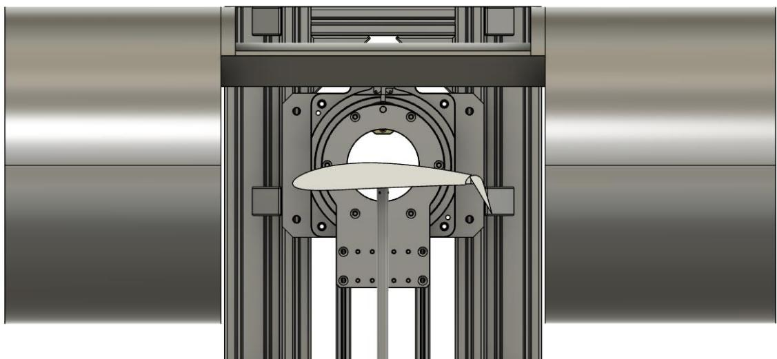
Slika 9: Bočni prikaz NACA 4412 modela sa spuštenim zakrilcem
