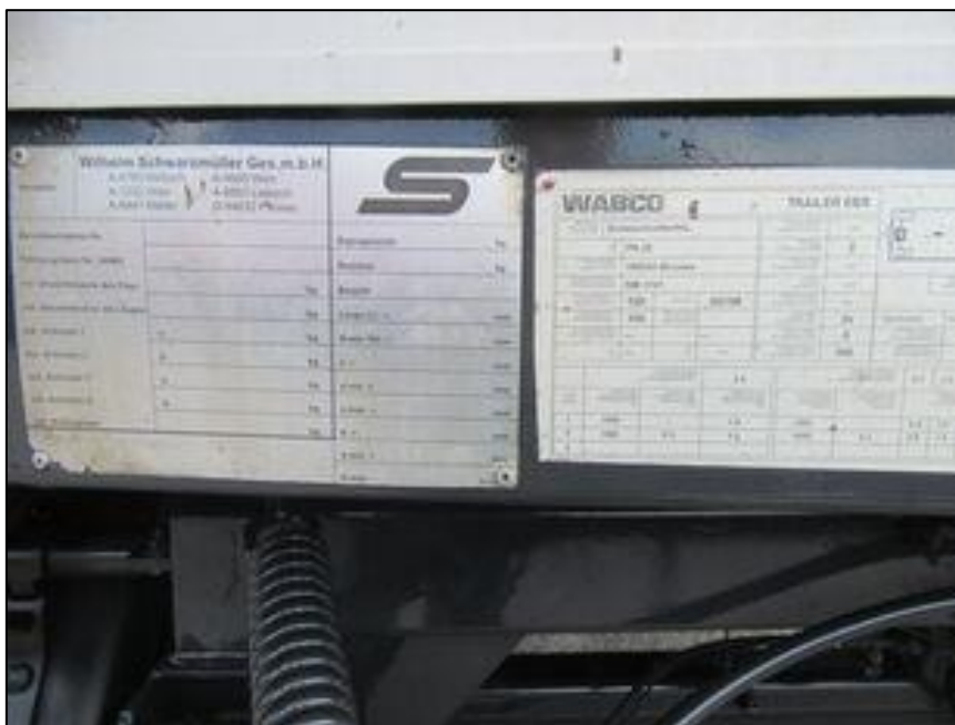
Slika 15. Eksploatacijske značajke dvoosovinske prikolice s ceradom SCHWARZMÜLLER proizvođača marke STANDARD koje su postavljene na prednjoj strani prikolice, [38]
