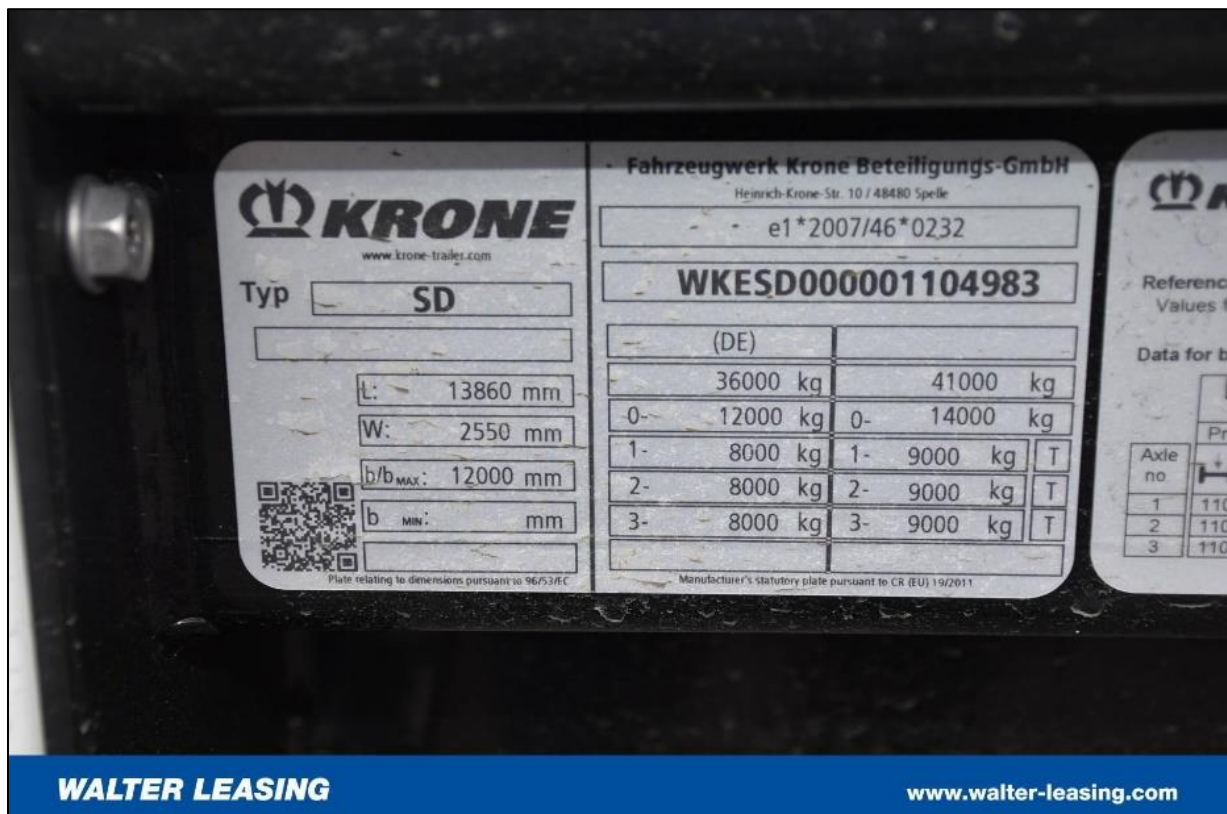
Slika 31. Eksploatacijske značajke troosovinske poluprikolice s ceradom KRONE proizvođača marke Profi Liner koje su postavljene na prednjoj strani poluprikolice, [47]
