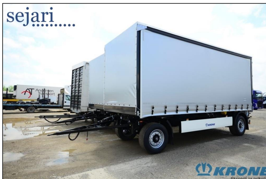
Slika 19. Vanjski izgled dvoosovinske prikolice s ceradom KRONE proizvođača marke Profi Carrier kod koje je prva osovina upravljiva zbog lakšeg upravljanja u uskim područjima, [42]
