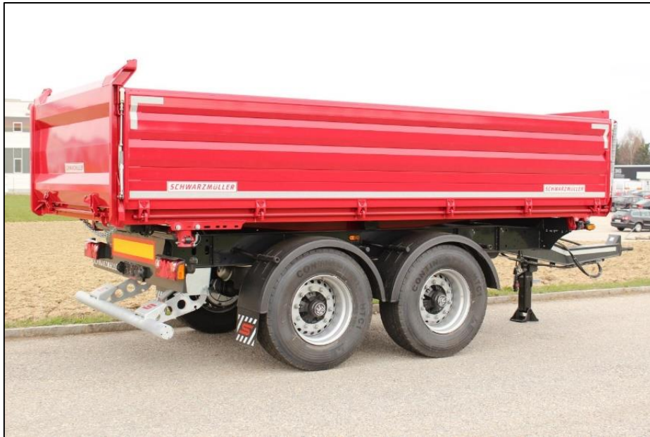
Slika 41. Vanjski izgled dvoosovinske prikolice kiper konstrukcije SCHWARZMÜLLER proizvođača s mogućnošću stražnjeg i bočnog podizanja utovarnog prostora, [51]
