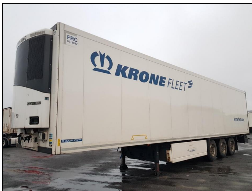
Slika 37. Vanjski izgled troosovinske poluprikolice s temperaturnim režimom rada KRONE proizvođača marke Cool Liner s rashladnim uređajem na prednjoj strani poluprikolice, [21]
