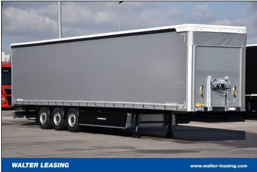
Slika 9. Prikaz suvremene europske standardne troosovinske poluprikolice SCHWARZMÜLLER proizvođača marke POWER LINE, [35]
