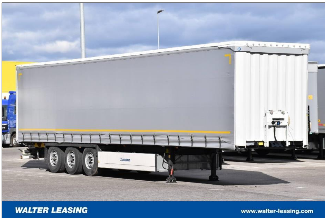
Slika 27. Prikaz troosovinske poluprikolice s ceradom KRONE proizvođača marke Profi Liner s dugim kopčama za zatvaranje teretnog prostora, [47]
