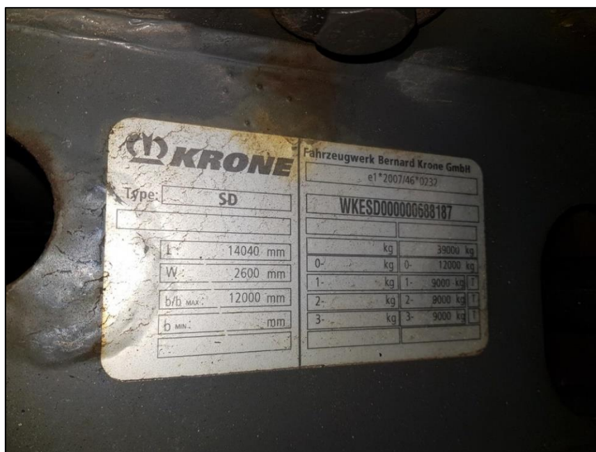
Slika 38. Eksploatacijske značajke troosovinske poluprikolice s temperaturnim režimom rada KRONE proizvođača marke Cool Liner koje su postavljene na prednjoj strani poluprikolice, [21]
