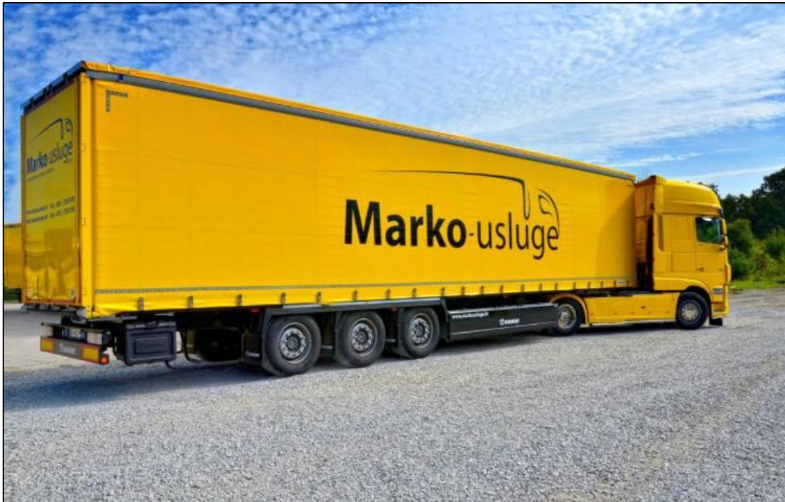
Slika 28. Prikaz troosovinske poluprikolice s ceradom KRONE proizvođača marke Profi Liner s metalnim kopčama za zatvaranje teretnog prostora, [48]
