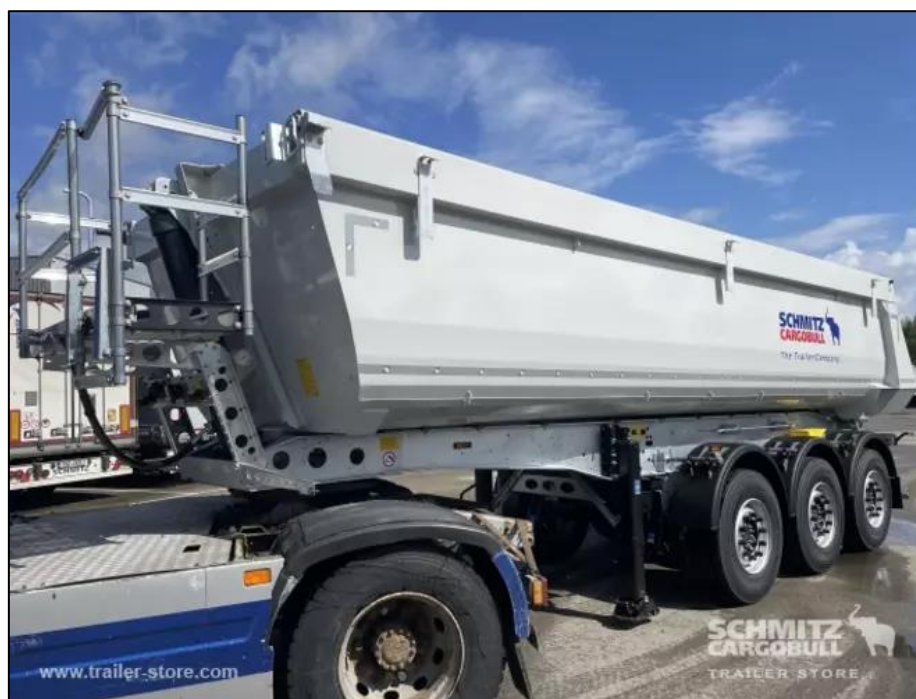
Slika 46. Vanjski izgled troosovinske poluprikolice kiper konstrukcije SCHMITZ proizvođača marke S.KI SOLID s mogućnošću stražnjeg podizanja utovarnog prostora, [25]
