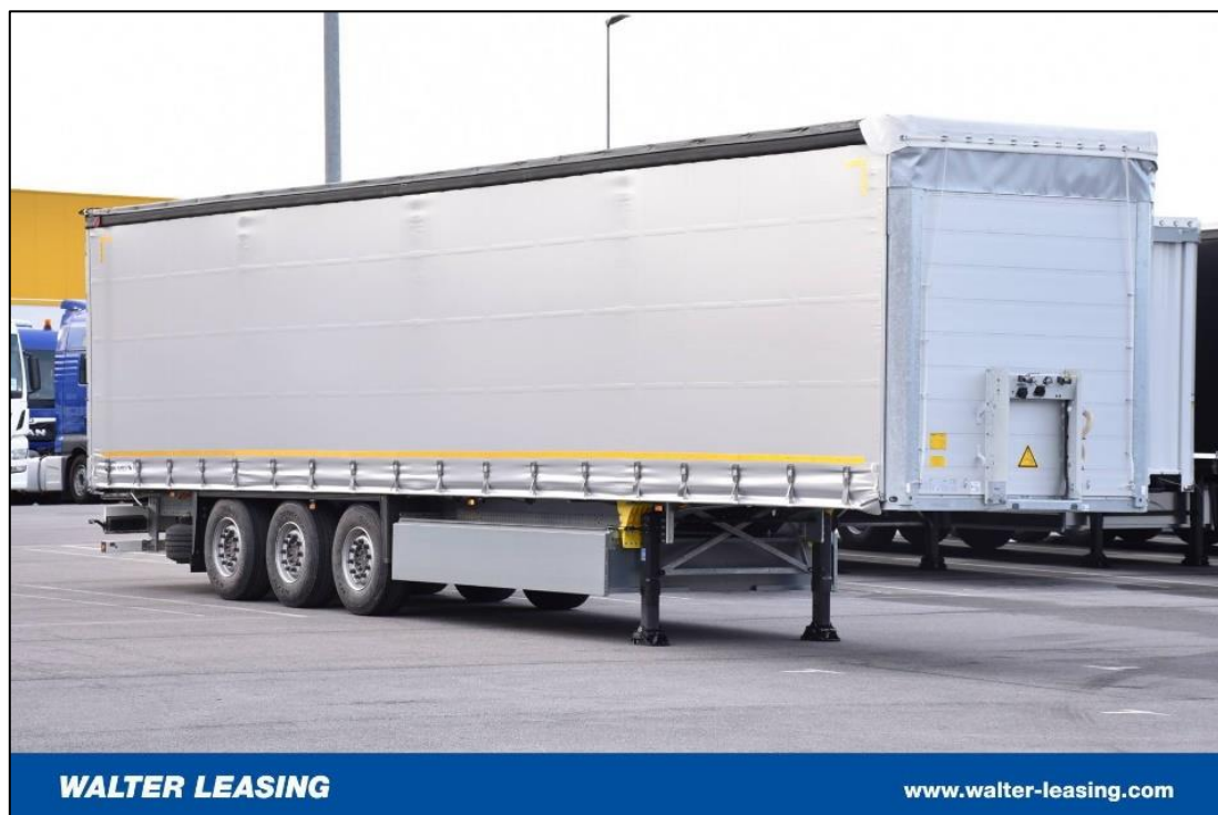
Slika 24. Vanjski izgled troosovinske poluprikolice s ceradom SCHMITZ proizvođača u standardnoj izvedbi, [44]
