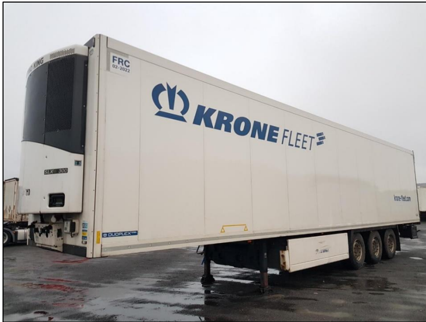
Slika 37. Vanjski izgled troosovinske poluprikolice s temperaturnim režimom rada KRONE proizvođača marke Cool Liner s rashladnim uređajem na prednjoj strani poluprikolice, [21]
