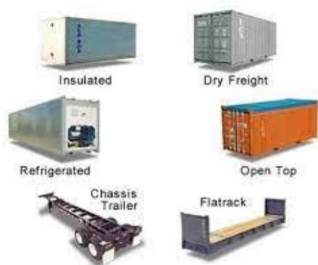
Slika 2: Intermodalne transportne jedinice 5
