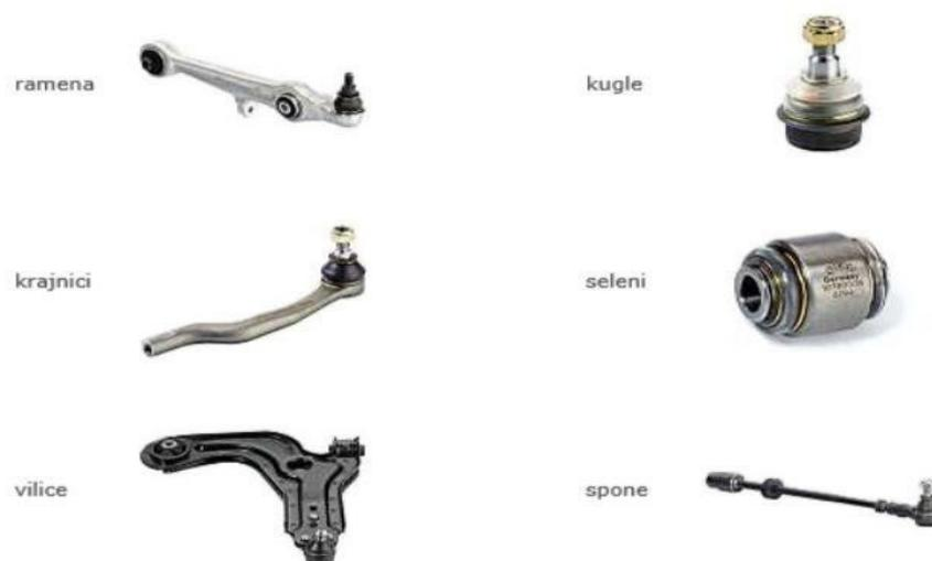
Slika 34. Dijelovi ovjesa vozila
