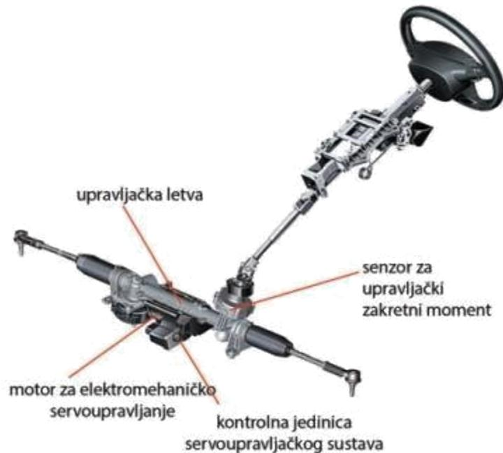
Slika 20. Električni servo upravljač smješten na upravljačkoj letvi
