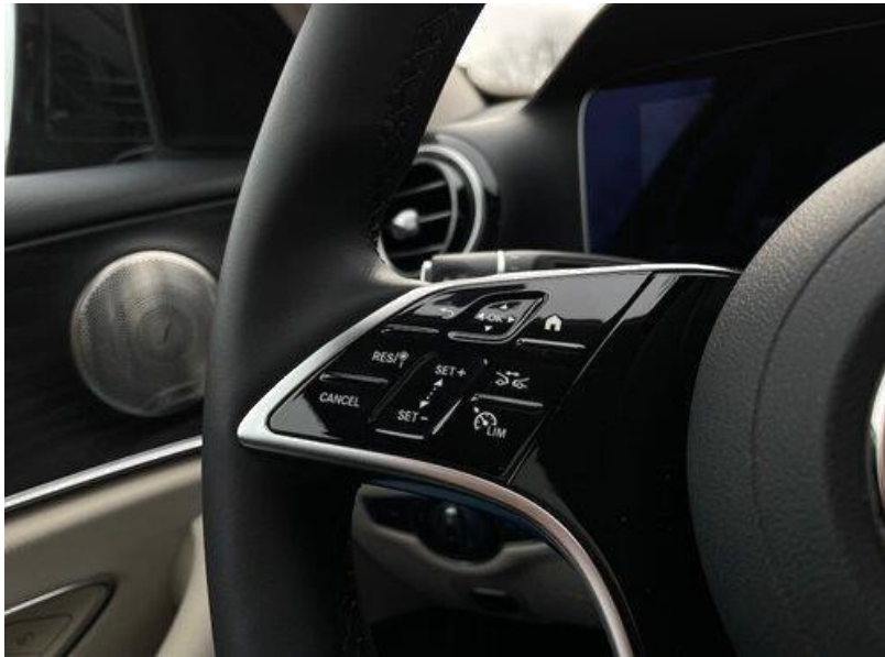
Slika 28. Kontrola adaptivnog tempomata na upravljaču
