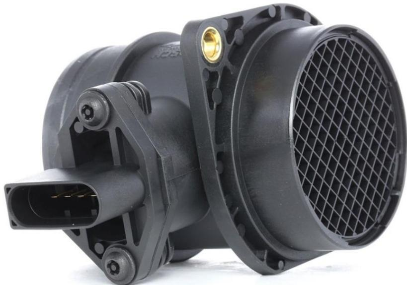
Slika 2 prikaz senzora masenog protoka zraka, [18]
