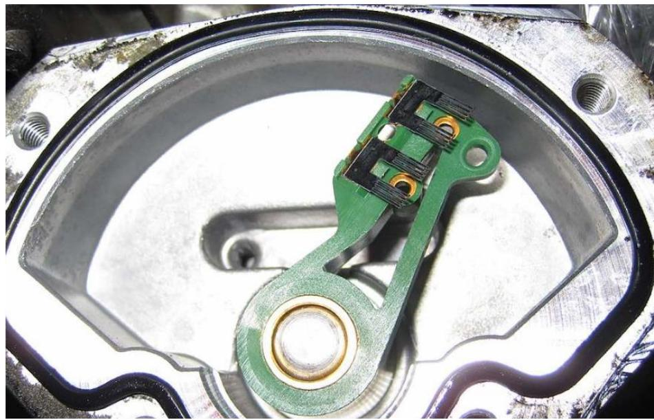
Slika 6 prikaz senzora položaja klapne gasa, [22]
