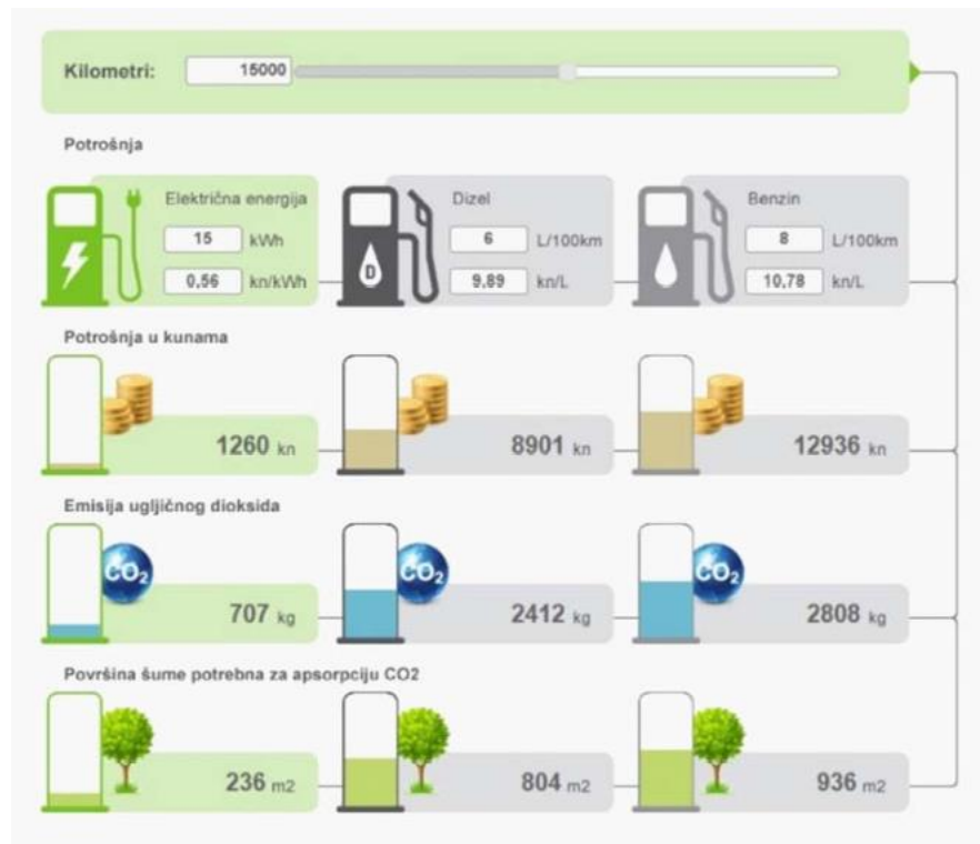
Slika 11. . Izračun potrošnje goriva i utjecaja na okoliš s aspekta električne energije, [25]
