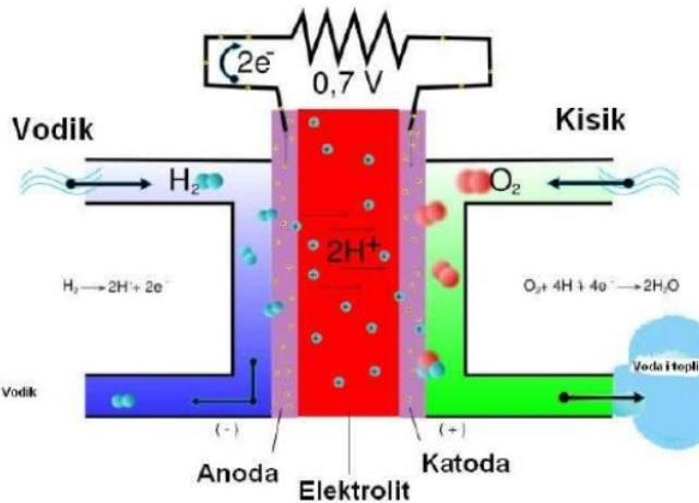
Slika 10. Princip rada gorive čelije, [26]
