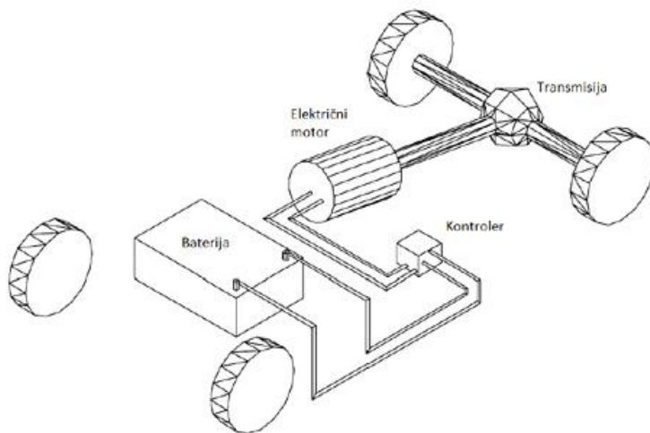
Slika 12. Shematski prikaz primarnih elemenata električnog pogona vozila, [26]
