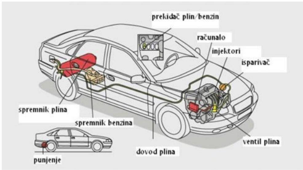
Slika 4. Shematski prikaz instalacije prirodnog plina u cestovnom motornom vozilu, [11]
