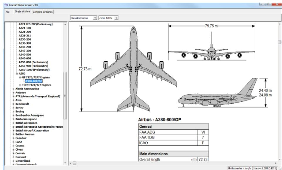
Slika 13. Tehnički podaci zrakoplova
