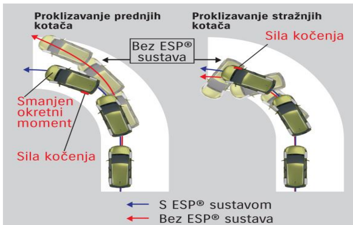
Slika 20. Djelovanje ESP sustava
