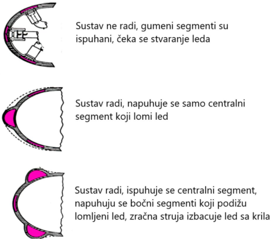
**Slika 11.** Shematski prikaz pneumatskog načina odleđivanja gumenim segmentima
