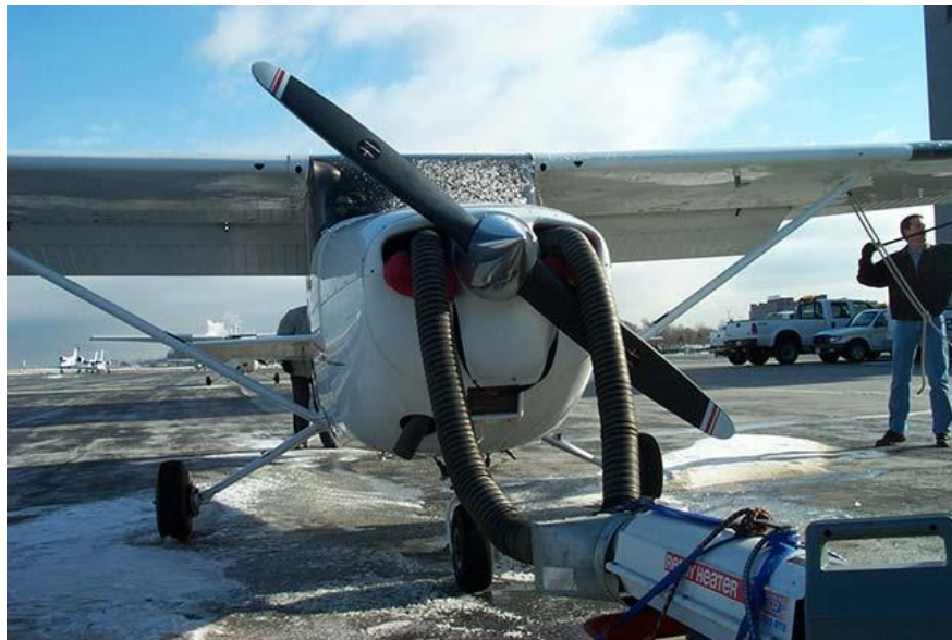
Slika 9. Odleđivanje motora vrućim zrakom
