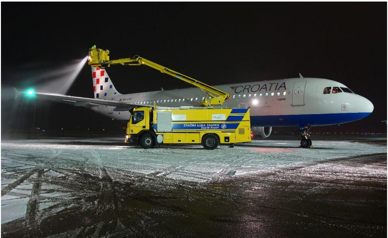
**Slika 4.** Tekući (kemijski) način zaštite od zaleđivanja
