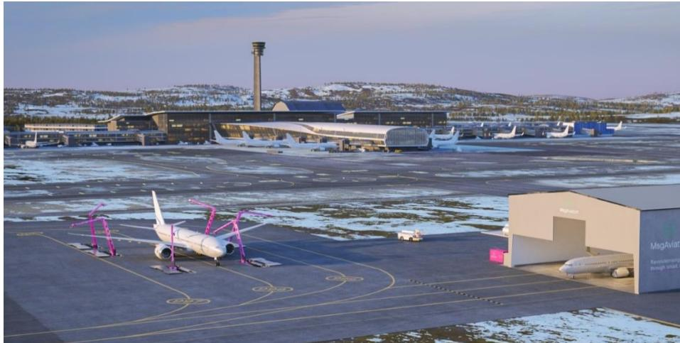
**Slika 13.** Korištenje robotske tehnologije za odleđivanje zrakoplova
