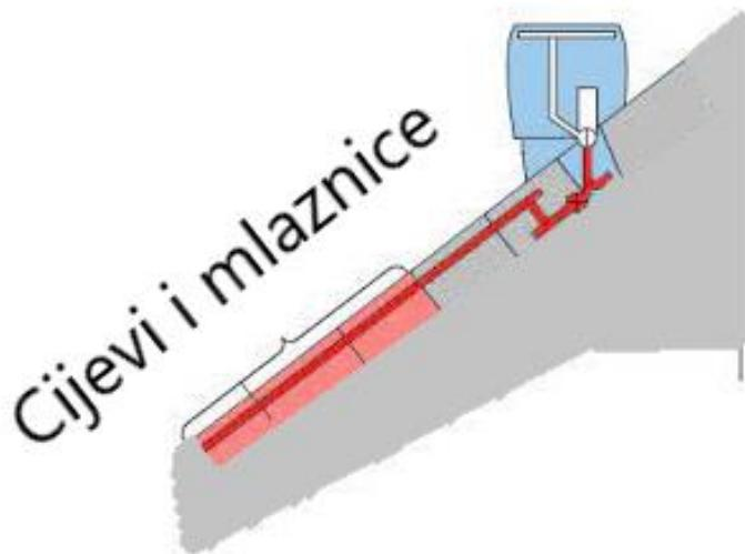
**Slika 2.** Shematski prikaz zaštite od zaleđivanja toplim zrakom
