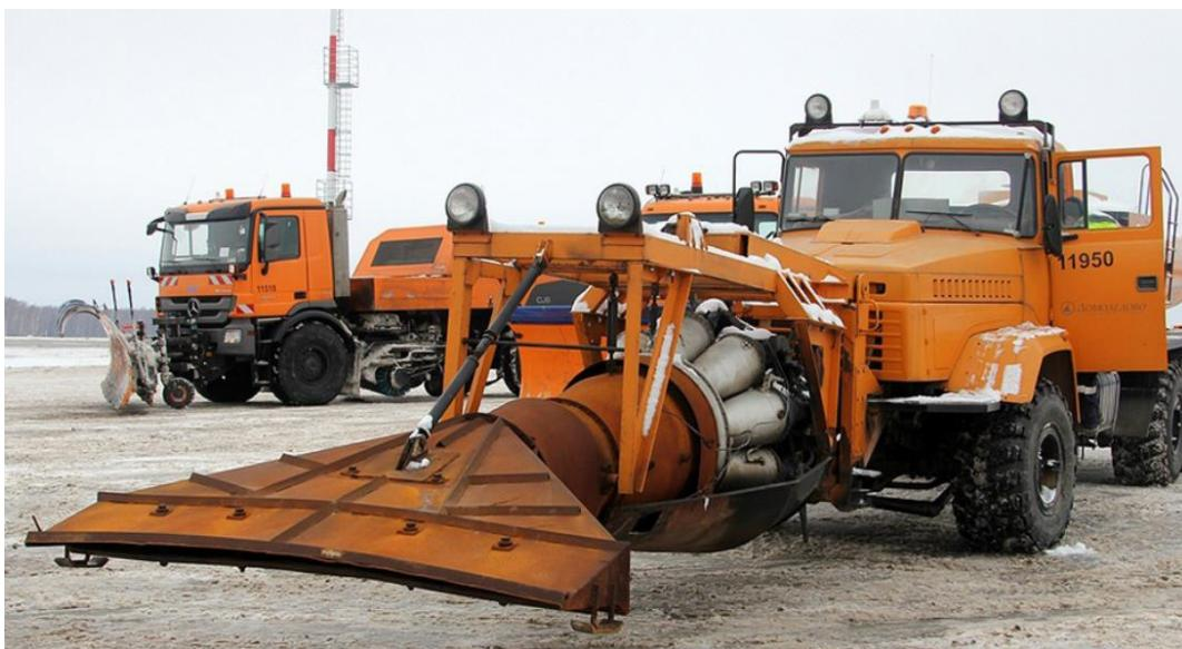
**Slika 15.** Vozilo s mlaznim motorom za čišćenje manevarske površine
