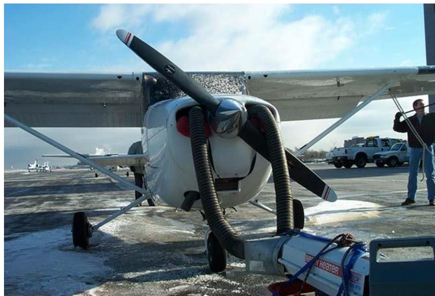
**Slika 9.** Odleđivanje motora vrućim zrakom
