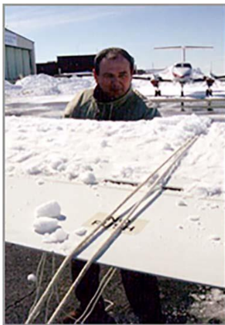
Slika 8. Metoda uklanjanja kontaminata uz pomoć užadi
