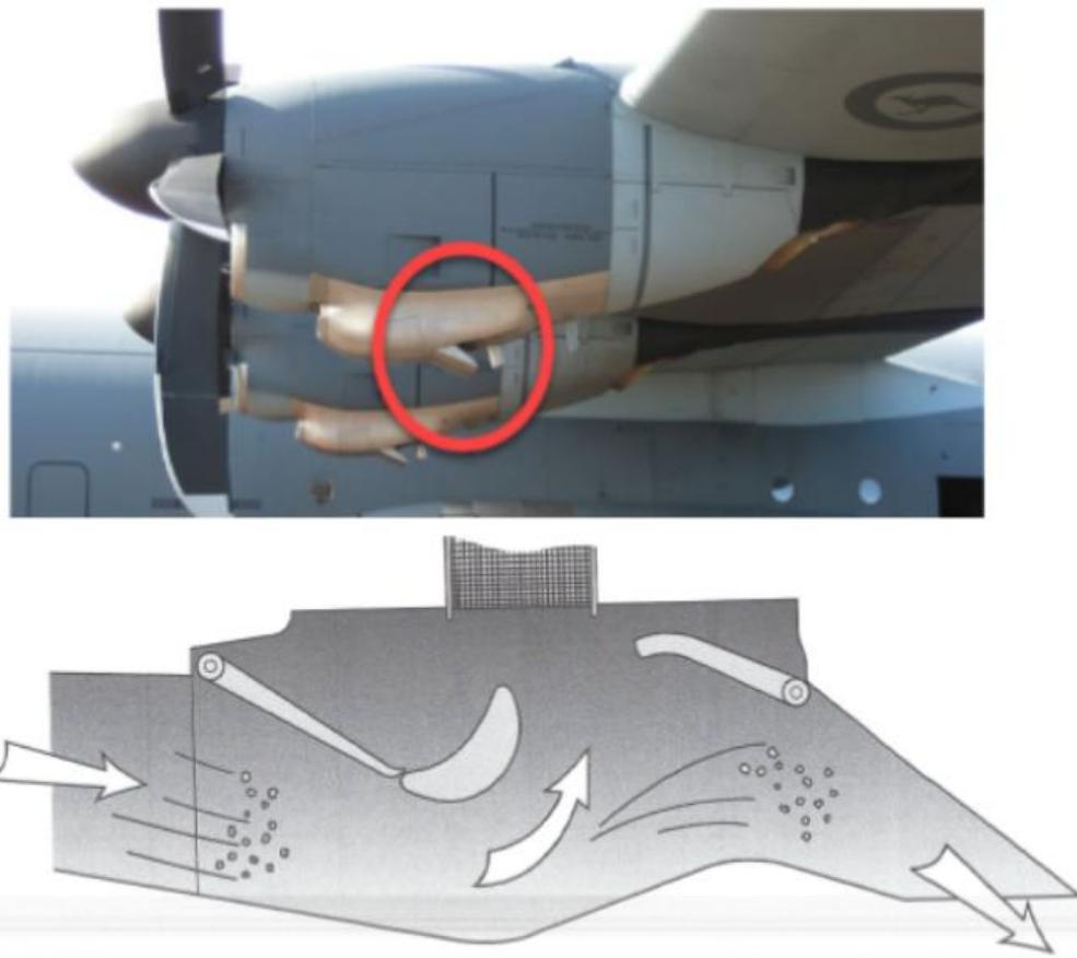
**Slika 16.** Separator leda i pijeska na turbo-propelerskim motoru
