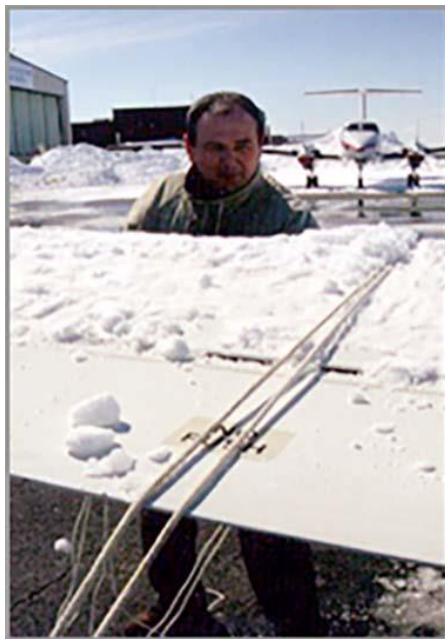
Slika 8. Metoda uklanjanja kontaminata uz pomoć užadi
