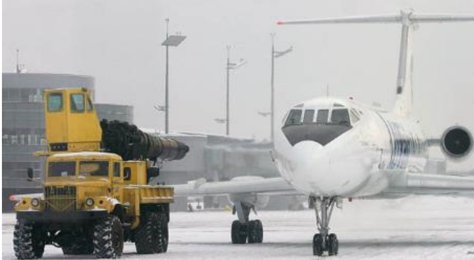
Slika 10. Mlazni motor kao izvor vrućeg zraka za odleđivanje zrakoplova
