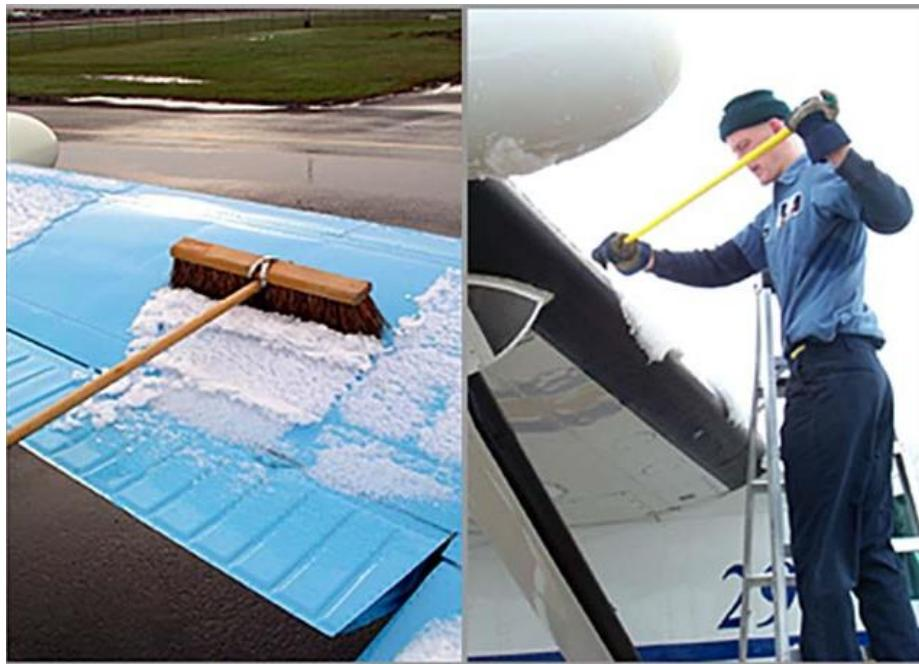
**Slika 7.** Mehaničko skidanje snijega metlom
