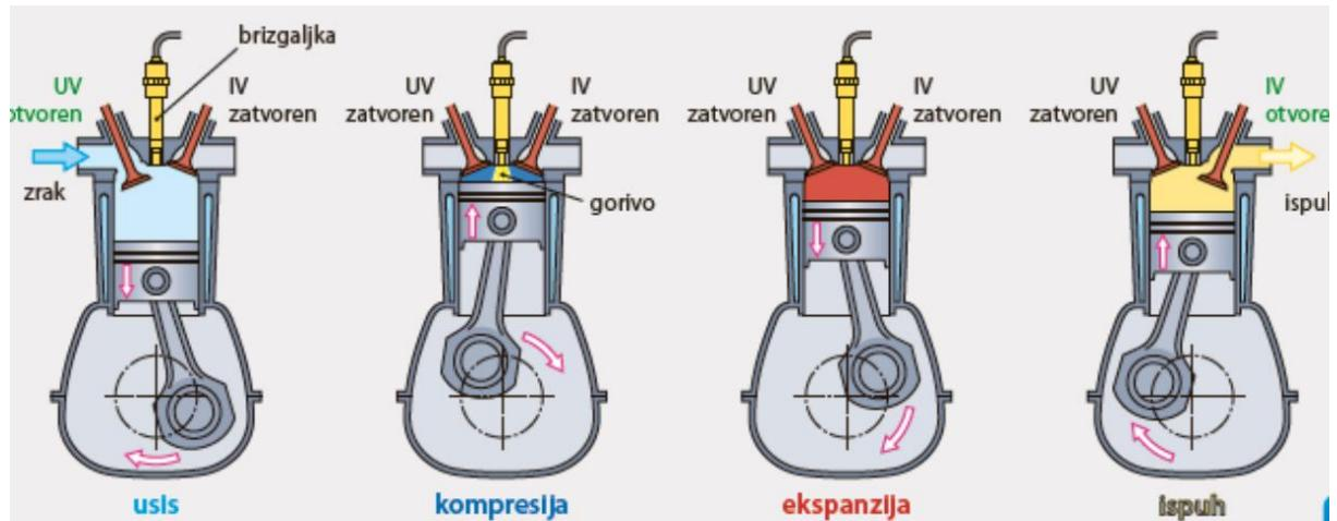
Slika 5. Taktovi Dieselova motora s izravnim ubrizgavanjem
