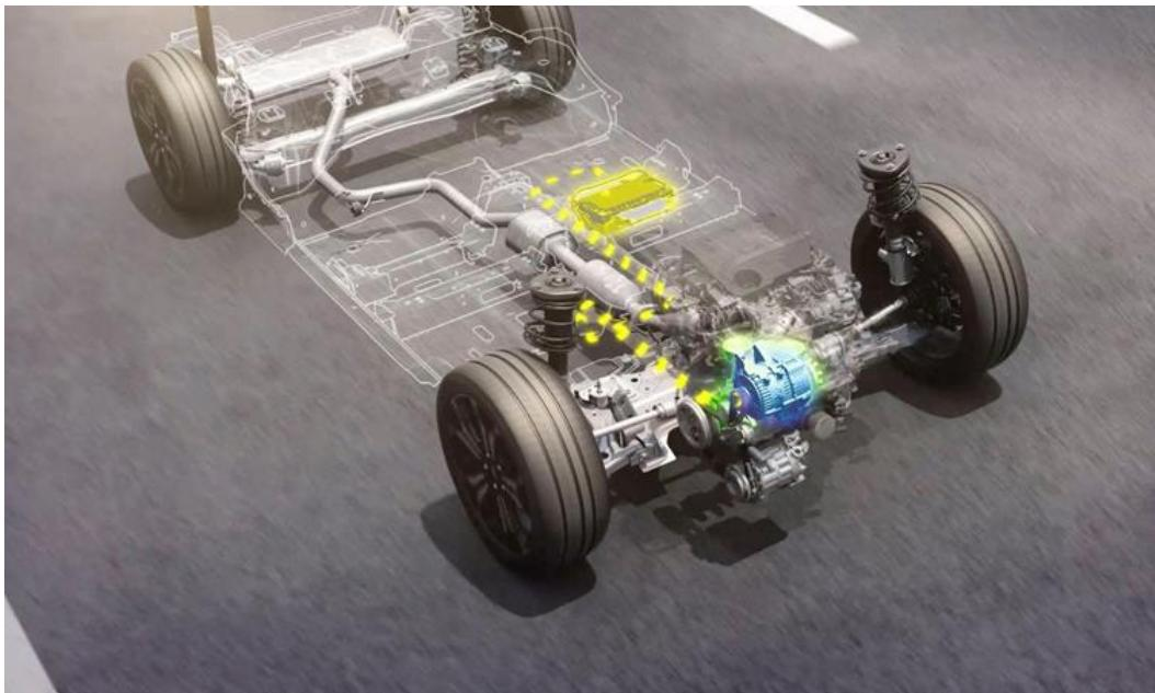
Slika 22. Hibridni pogonski sklop Ford Transit Custom
