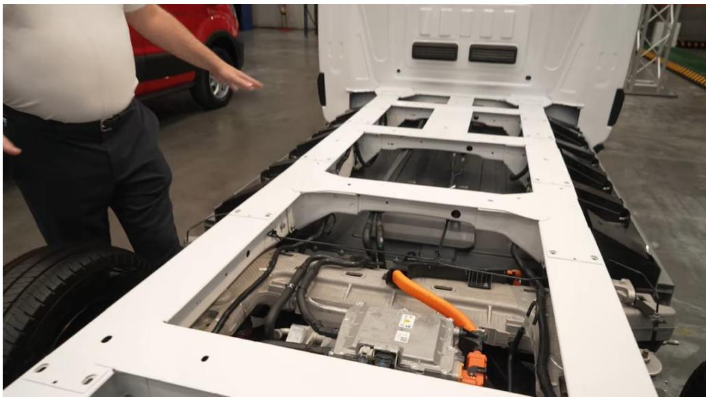
Slika 25. Pogonski sklop Ford E-Transita
