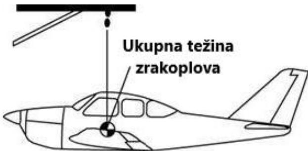
Slika 1. Težište zrakoplova
