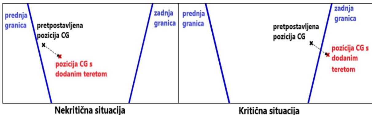
**Slika 13.** Nova pozicija težišta uslijed pozitivnog momenta
