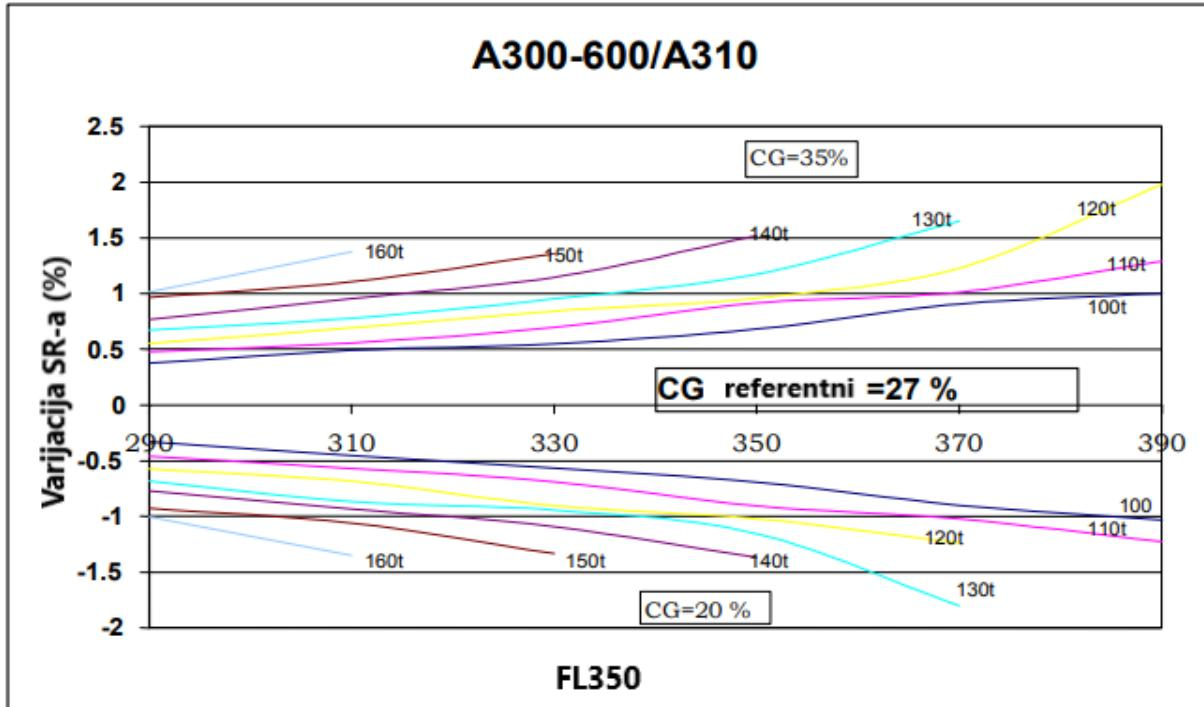
**Slika 24.** Varijacija specifičnog doleta ovisno o poziciji težišta i masi zrakoplova
