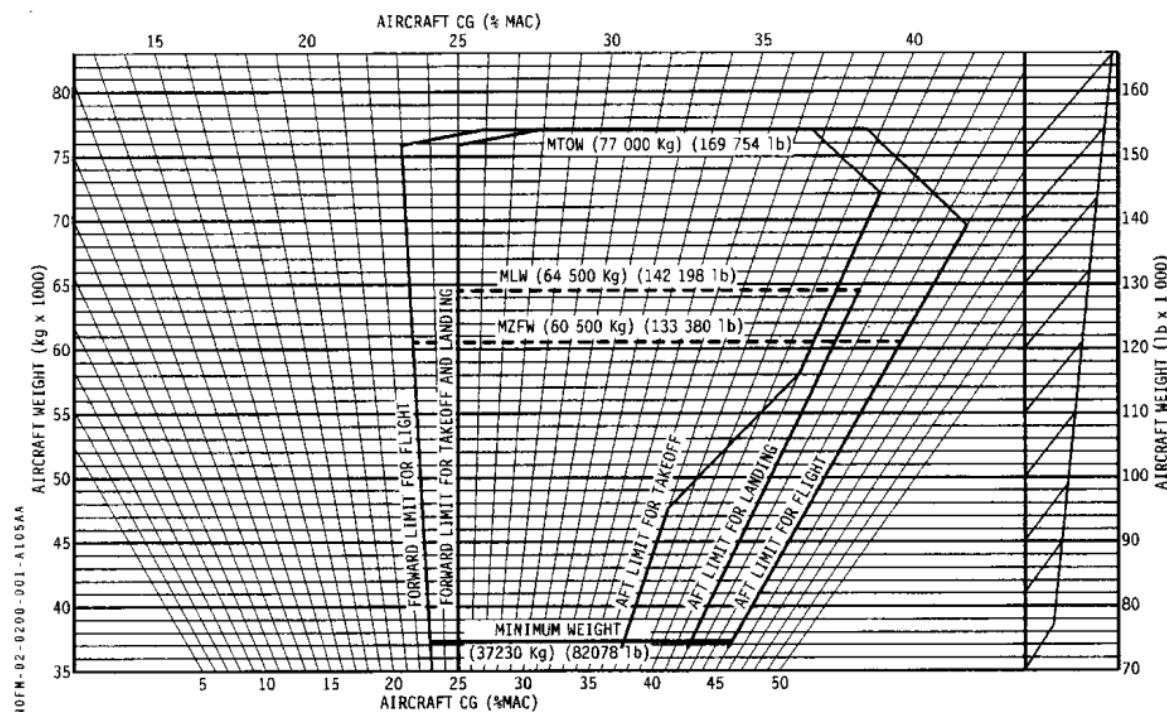
Slika 23. Limiti pozicije težišta za zrakoplov A320
