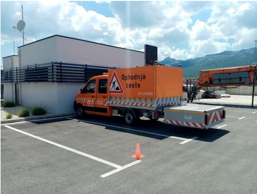
Slika 40: Ophodarsko vozilo sa ublaživačem udara
