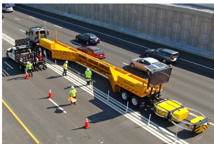
Slika 38: Mobilna zaštitna ograda
