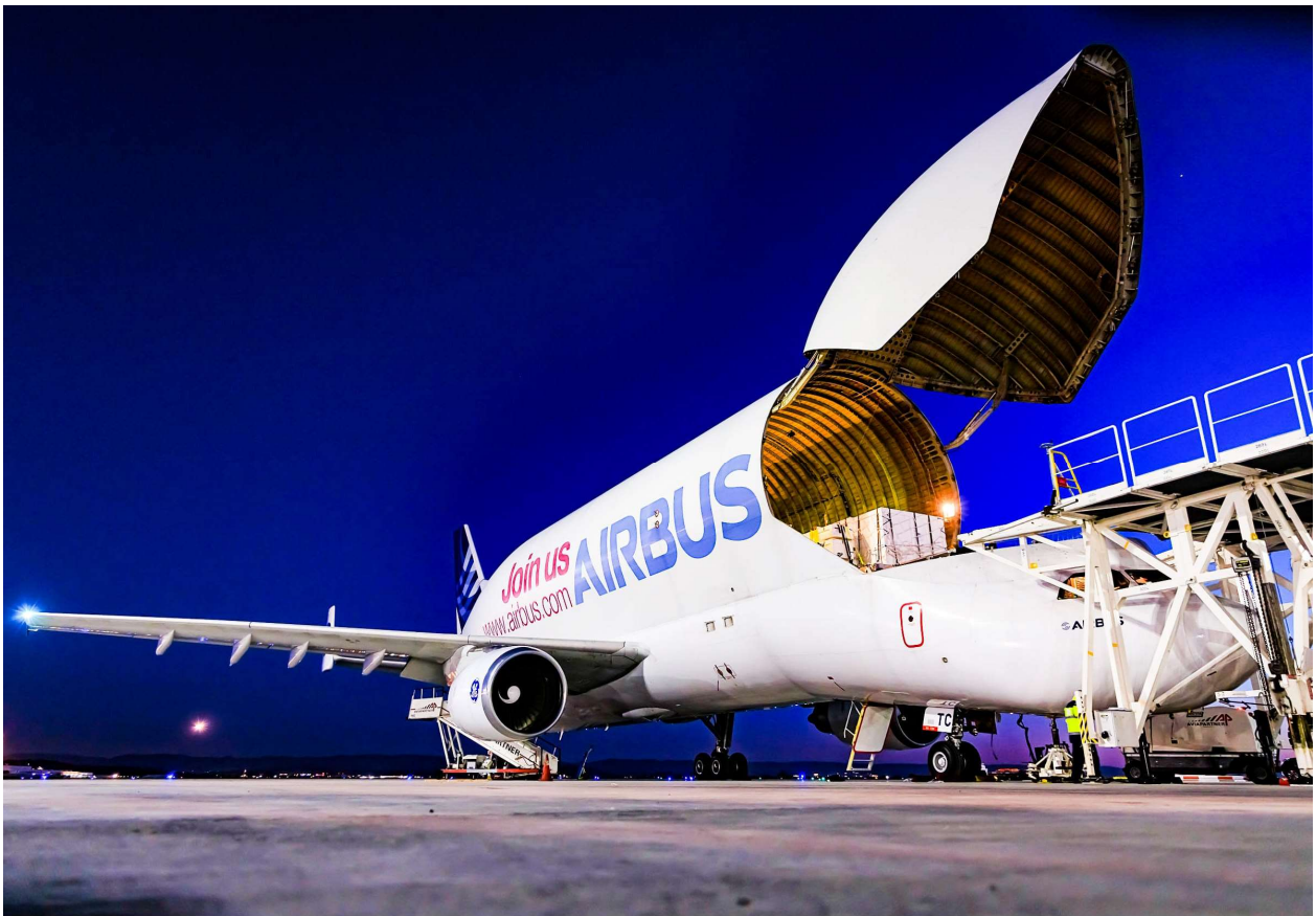
Slika 26: Puluautomatski sustav utovara BelugaST na glavnoj palubi
