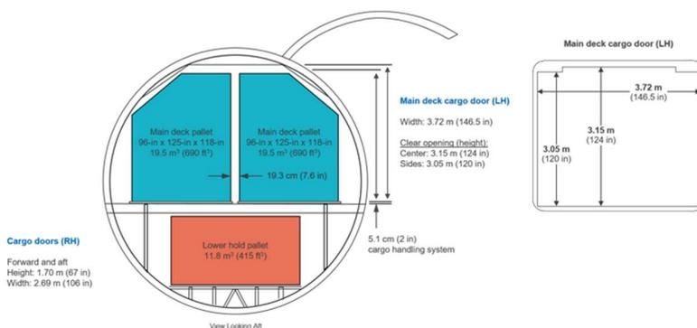
**Slika 33: Poprečni presjek tovarnog prostora Boeing-a 777-8F**
