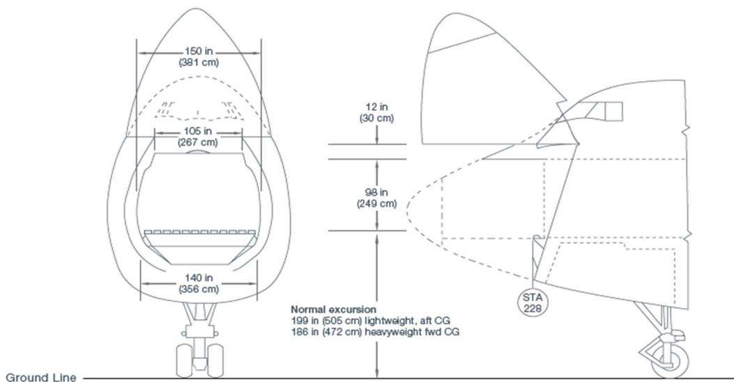
**Slika 30: Vrata na nosu zrakoplova Boeing 747-8F**
