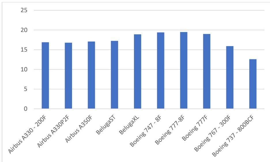
**Grafikon 17: Usporedba visine Airbus i Boeing zrakoplova**
