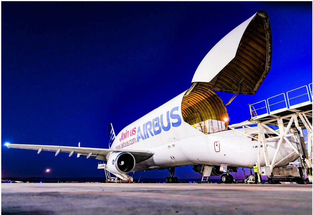
**Slika 26: Puluautomatski sustav utovara BelugaST na glavnoj palubi**
