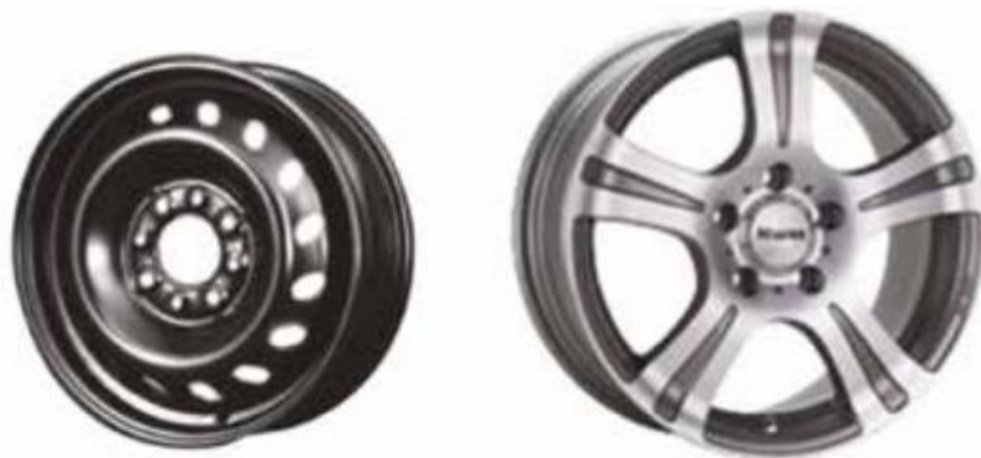
Slika 28. Naplatak od čeličnog lima i aluminijske legure
