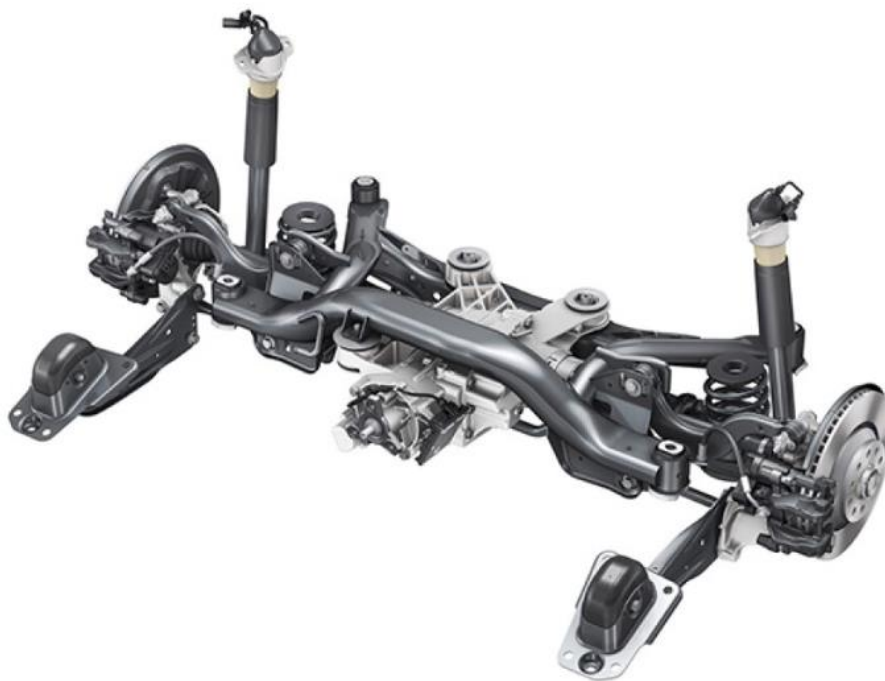
Slika 20. Neovisni ovjes stražnjih kotača
