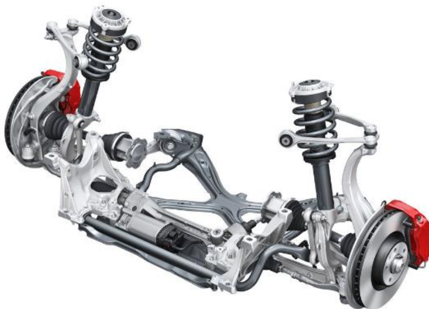
Slika 17. Ovjes s dvije poprečne vodilice
