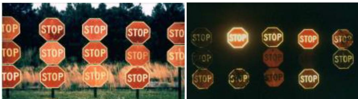
Slika 6. Kvaliteta retrorefleksije pojedinih znakova
