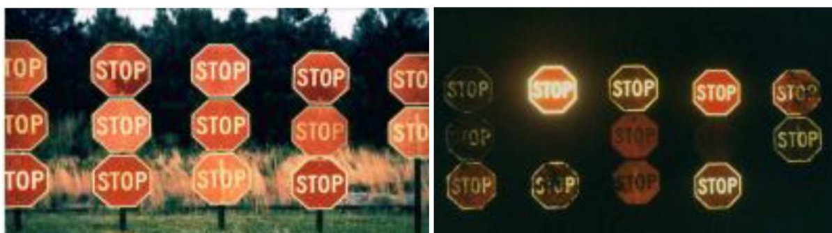
Slika 6. Kvaliteta retrorefleksije pojedinih znakova
