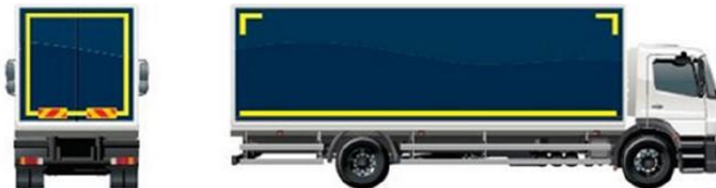
Slika 25. Primjer djelomične konture na vozilu
