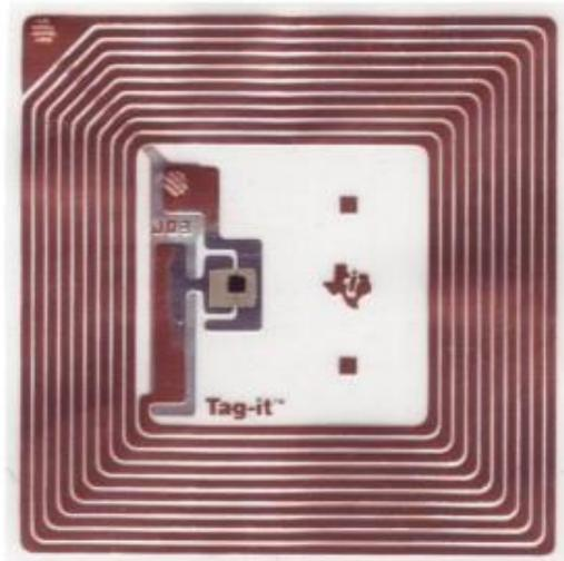
Slika 7. RFID tag – antena i mikročip, [18]
