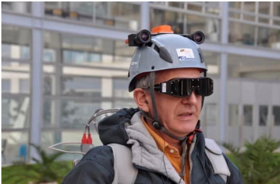
Slika 20. Prototip CASBlip nosivog uređaja, [40]
