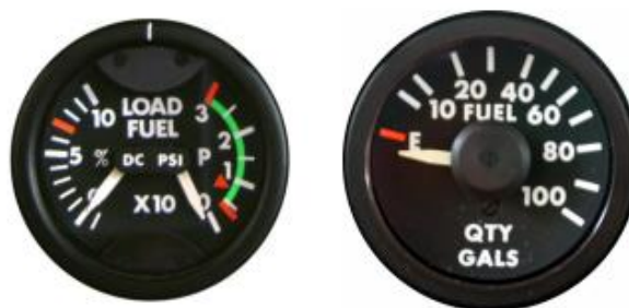
Slika 4. Instrumenti za mjerenje tlaka i količine goriva [1]
