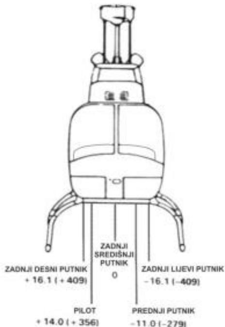
**Slika 14.** Udaljenost pojedinih točaka na helikopteru lijevo (-) i desno (+) od poprečne osi u in (mm)
